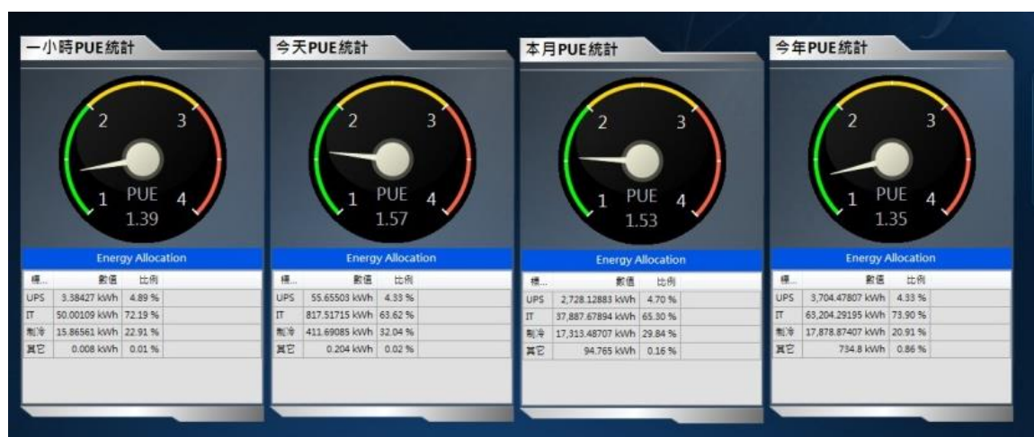
图 4：PUE 值监测仪表板
