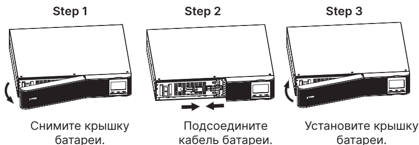
(Рис. 4-1: Подсоединение кабеля батареи)
