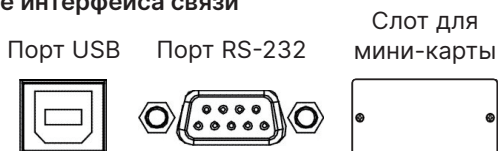
(Рис. 4-2: Подключение порта USB, порта RS-232 и слота для мини-карты)
