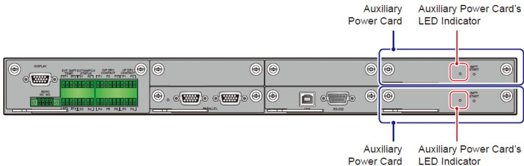
(Рис. 4-15: Расположение плат резервного питания)
