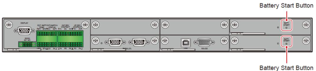
(Рис. 4-16: Расположение кнопок запуска аккумуляторной батареи)
