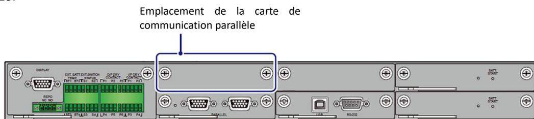
(Figure 4-10 : Emplacement du logement de la carte de communication parallèle)
