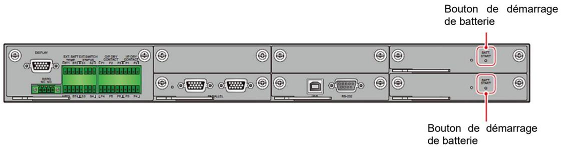
**(Figure 4-16 : Emplacement des boutons de démarrage de la batterie)**
