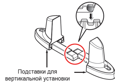
(Рисунок 4: Сборка подставок для вертикальной установки)
