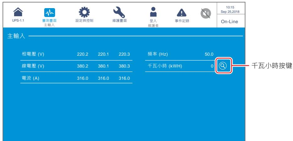
點選千瓦小時按鍵 (
