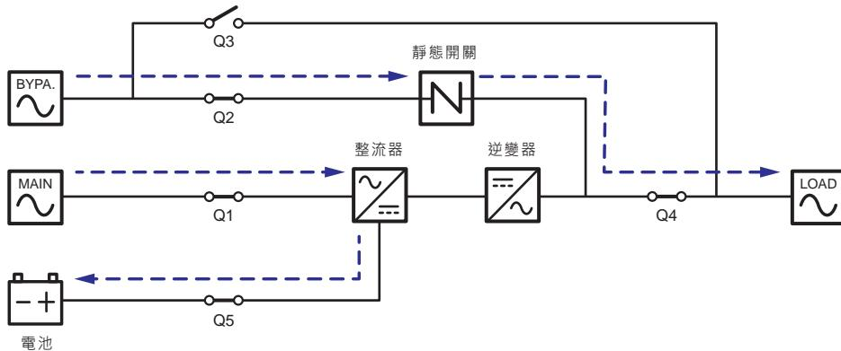
(圖 3-17：旁路模式狀態圖 \_ 雙迴路單機)
