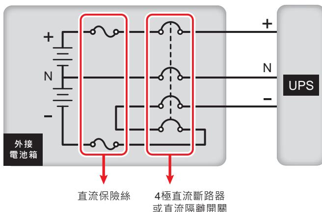
(圖 5-18：安裝 4 極直流斷路器或直流隔離開關串接直流保險絲 )
