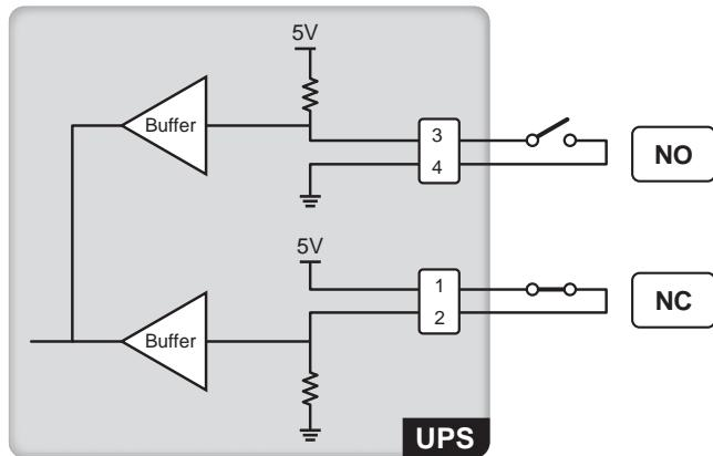
(圖 4-4：遠程緊急關機乾接點 (REPO) 腳位圖 )
