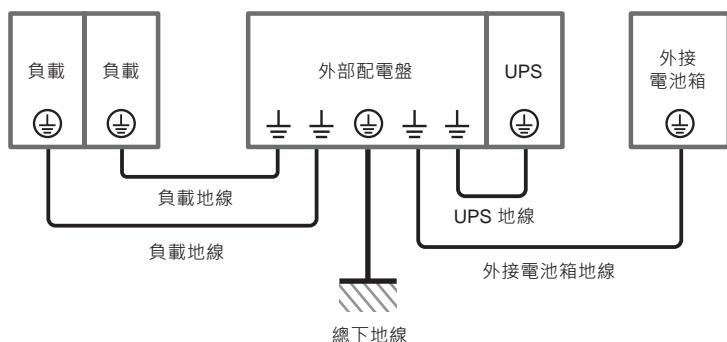
(圖 5-13 : 接地配線圖 \_ 單機 )
