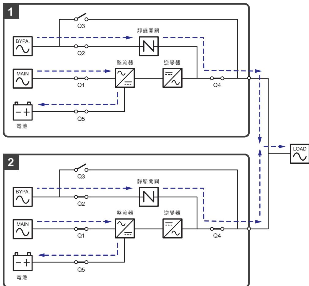
(圖 3-24：旁路模式狀態圖\_雙迴路並機)
