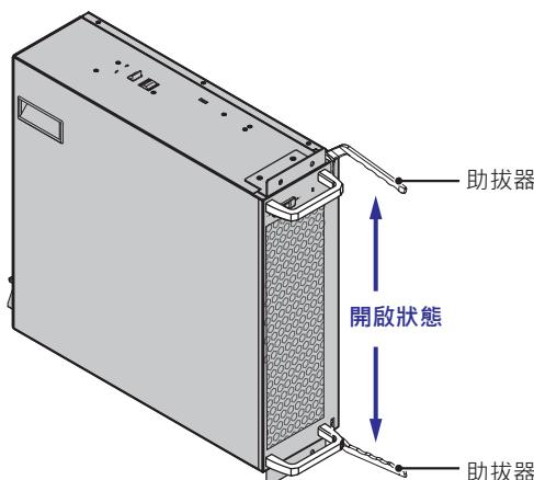
(圖 5-23：確認助拔器為開啟狀態置)
