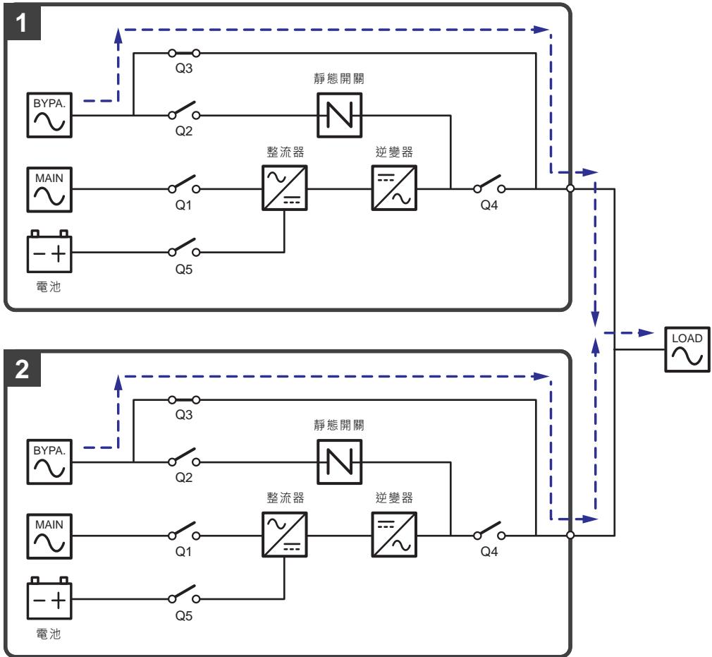
(圖 3-25：手動旁路模式狀態圖 \_ 雙迴路並機)
