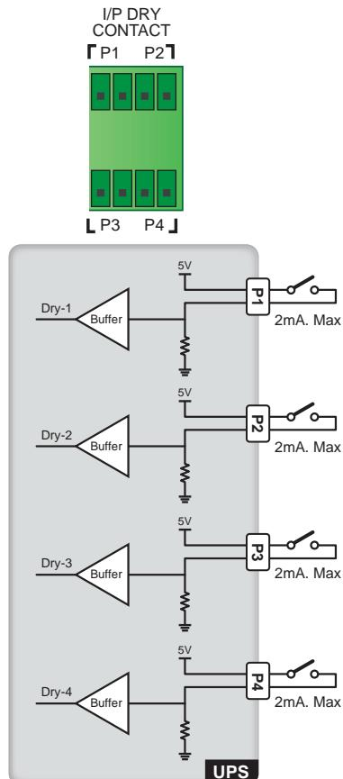
( 圖 4-10 : 輸入乾接點 (I/P DRY CONTACT) 腳位圖 )
