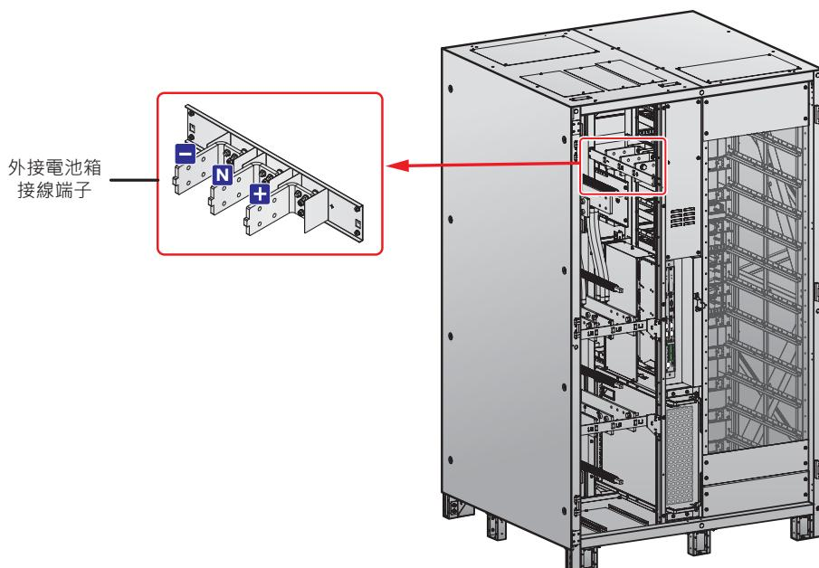
( 圖 2-8 : 外接電池箱接線端子 )
