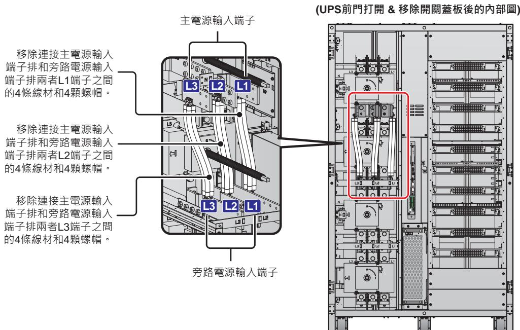
(圖 5-6：移除連接主電源輸入端子 (L1/ L2/ L3) 和旁路電源輸入端子 (L1/ L2/ L3) 之間的 12 條線材 )
