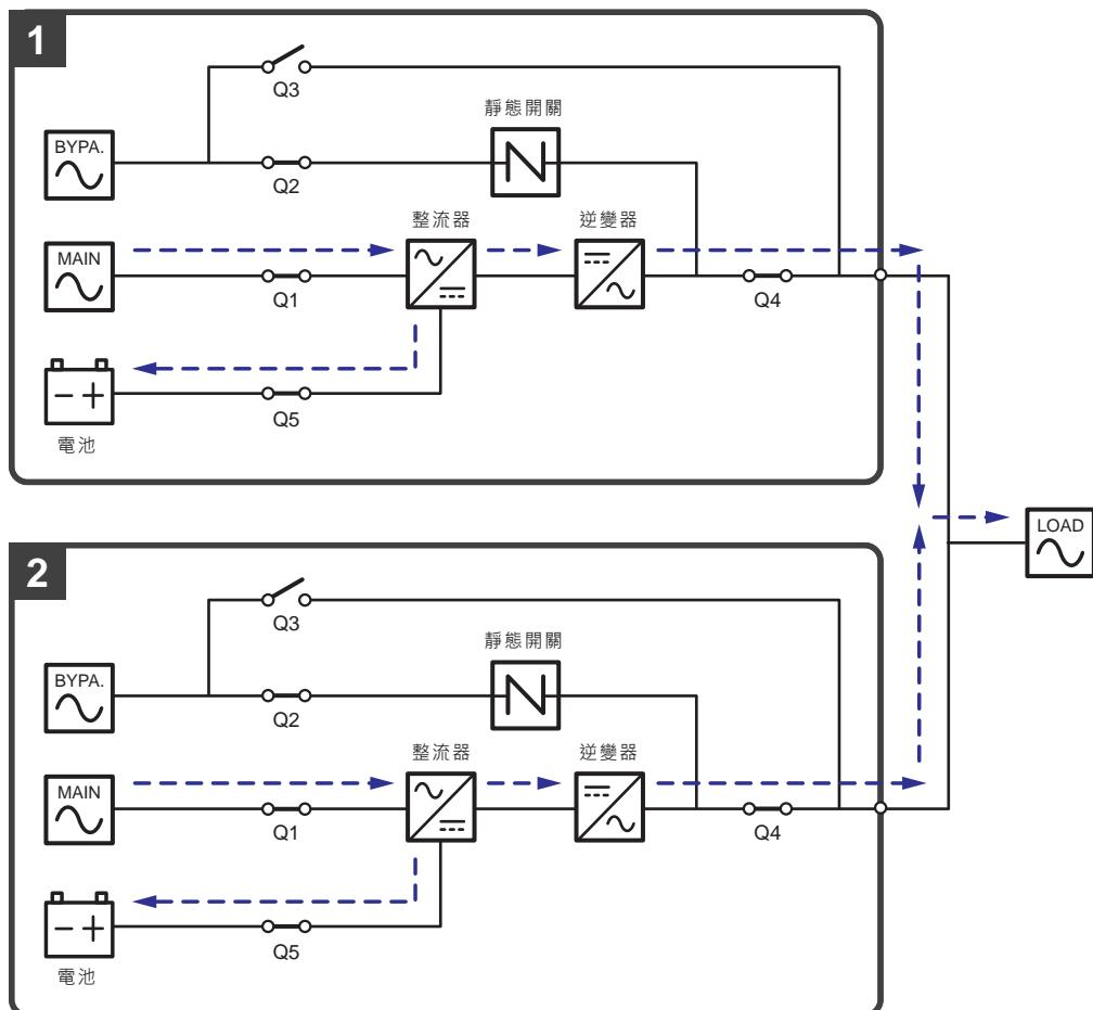
(圖 3-27：高效模式狀態圖 \_ 雙迴路並機)
