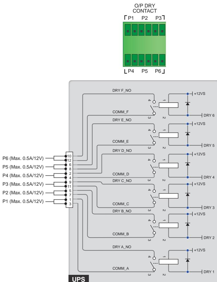
(圖 4-9：輸出乾接點 (O/P DRY CONTACT) 腳位圖)
