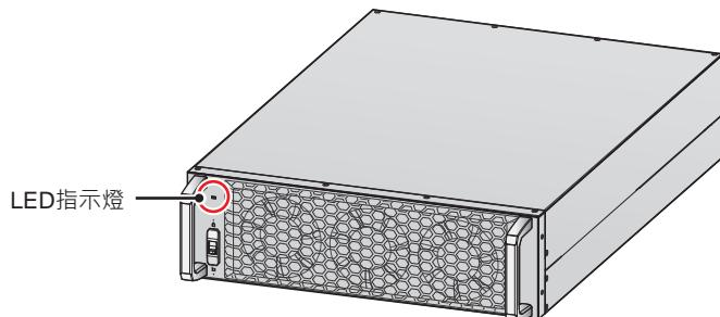
(圖 5-42：電源模組 LED 指示燈)
