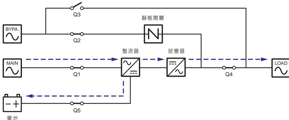
(圖 3-21：高效模式狀態圖 \_ 雙迴路單機 )
