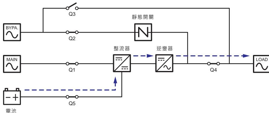
(圖 3-16：電池模式狀態圖 \_ 雙迴路單機)
