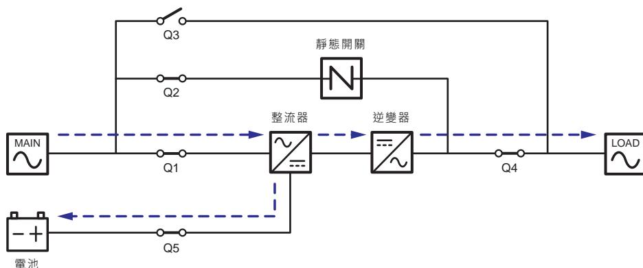
(圖 3-1：在線模式狀態圖 \_ 單迴路單機)
