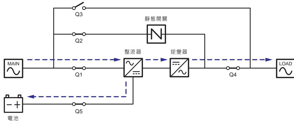
(圖 3-7 : 高效模式狀態圖\_單迴路單機 )
