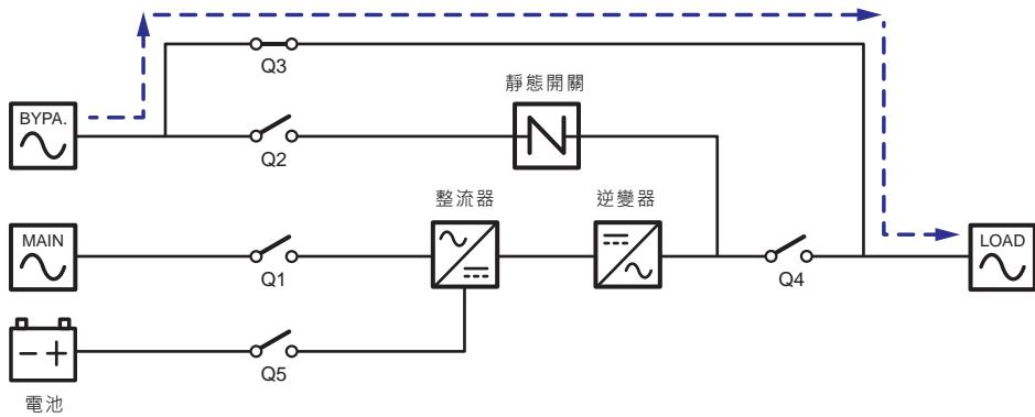
(圖 3-18：手動旁路模式狀態圖 \_ 雙迴路單機 )
