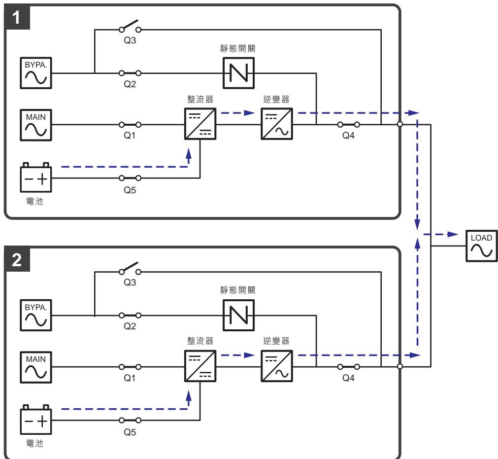
(圖 3-23：電池模式狀態圖 \_ 雙迴路並機)
