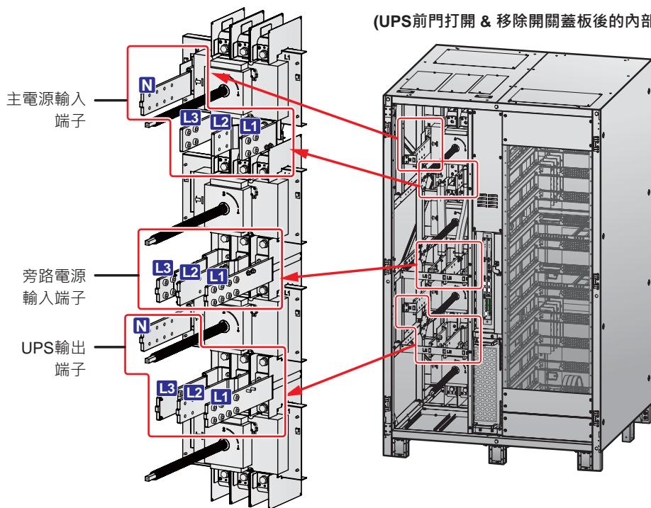
(圖 5-8：主電源輸入端子、旁路電源輸入端子 &amp; UPS 輸出端子)
