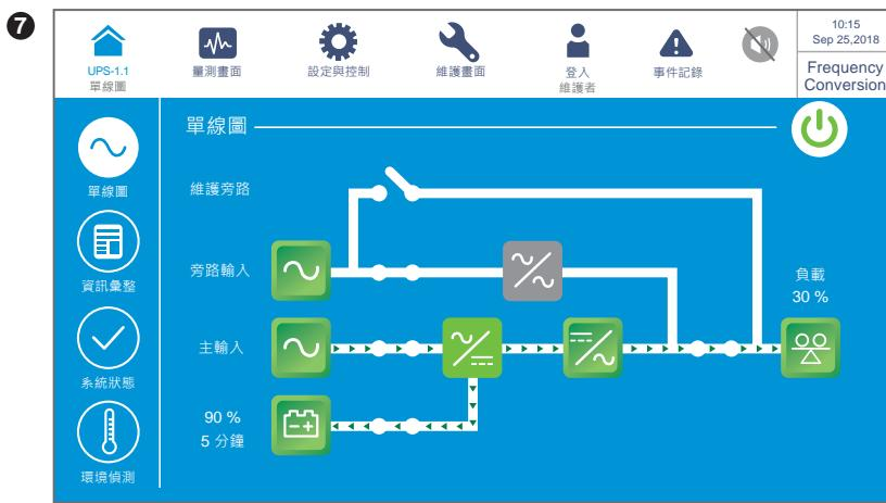
以上畫面表示 UPS 在頻率轉換模式 (Frequency Conversion) 下工作，限制旁路輸出。有關頻率轉換模式設定，請參閱 **7.10.2 模式設定及 6.2.6 頻率轉換模式開機程序**。
