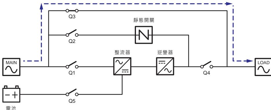
(圖 3-4：手動旁路模式狀態圖 \_ 單迴路單機)
