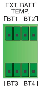
(圖 4-7：外接電池溫度偵測口 (EXT. BATT TEMP.) 腳位圖 )
