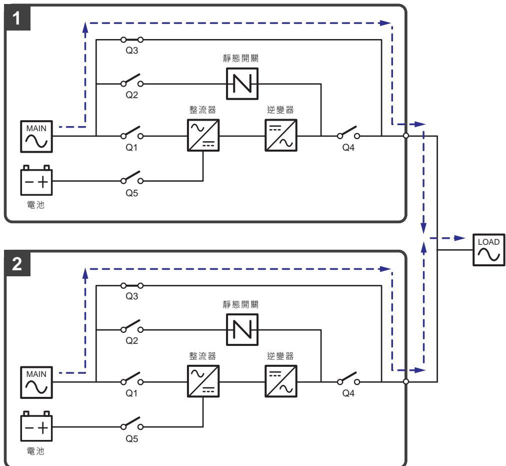
(圖 3-12：手動旁路模式狀態圖 \_ 單迴路並機 )
