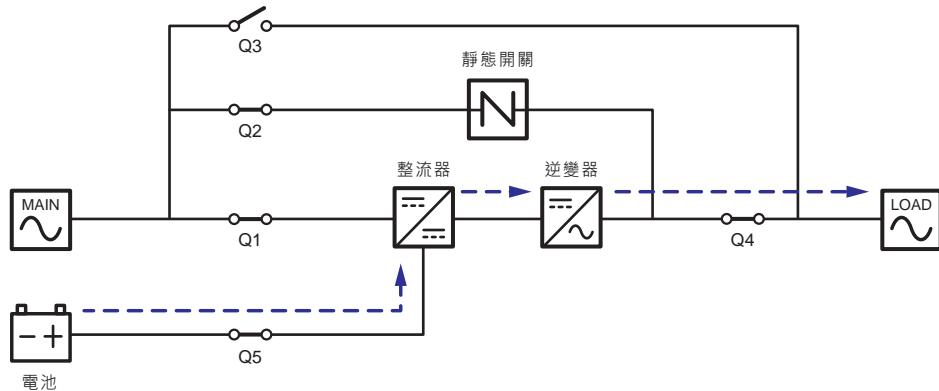
( 圖 3-2：電池模式狀態圖 \_ 單迴路單機 )
