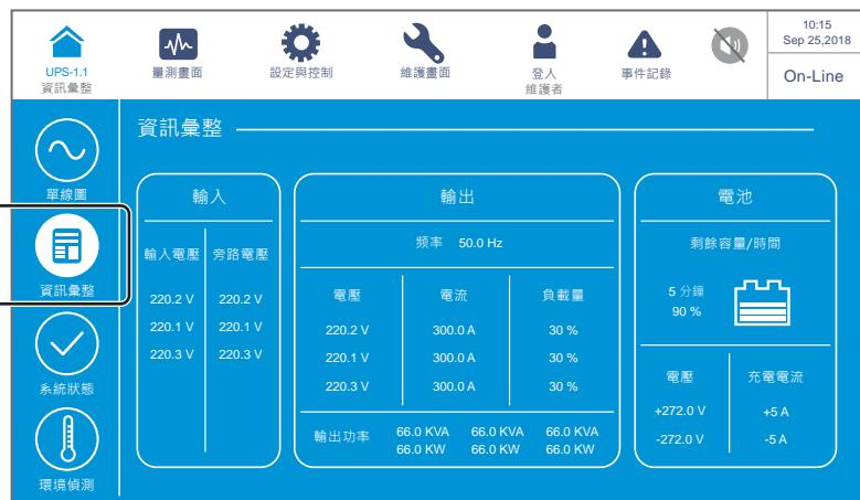
3. 點選
