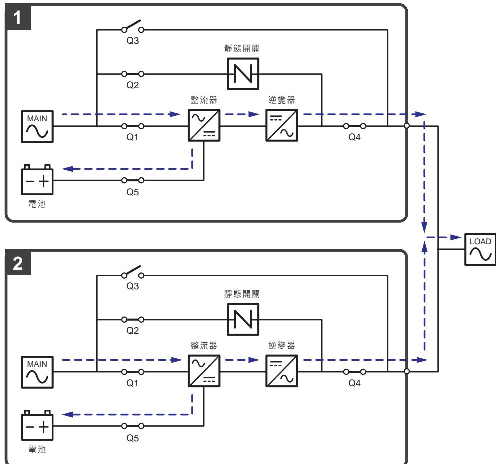
(圖 3-14：高效模式狀態圖 \_ 單迴路並機)
