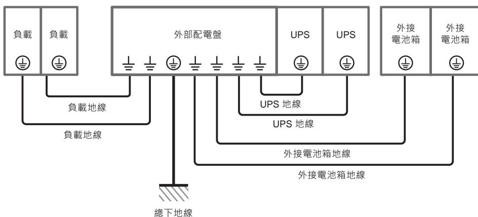
(圖 5-15：接地配線圖 \_ 並機 )
