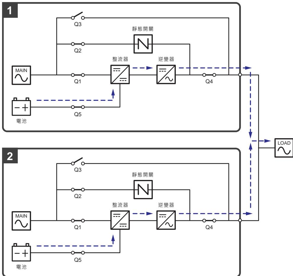
(圖 3-10：電池模式狀態圖 \_ 單迴路並機)
