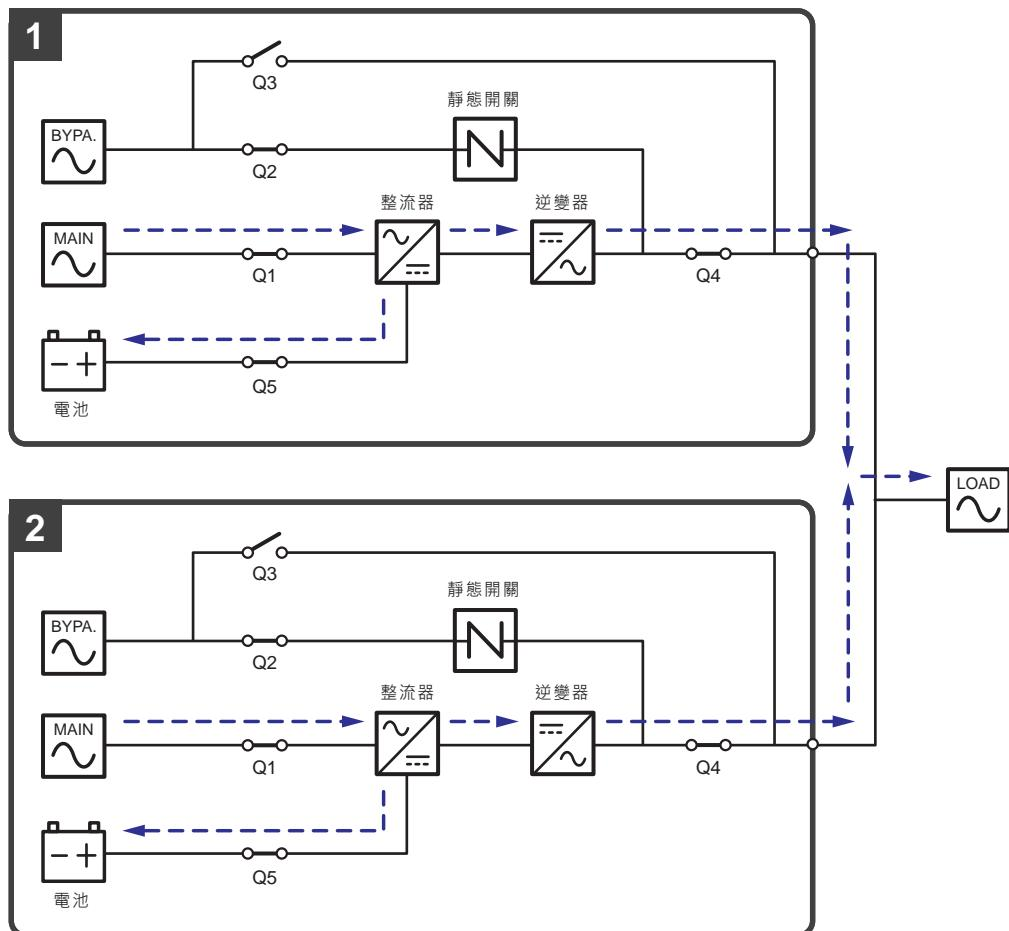
( 圖 3-22：在線模式狀態圖 \_ 雙迴路並機 )
