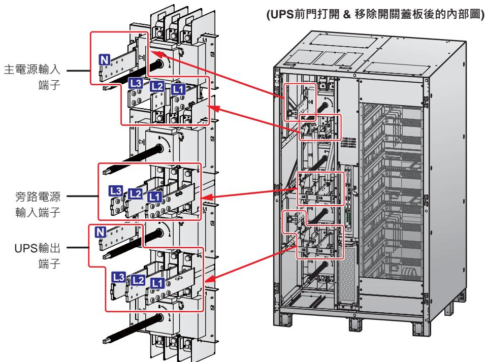
( 圖 2-7 : 主電源輸入端子、旁路電源輸入端子 &amp; UPS 輸出端子 )
