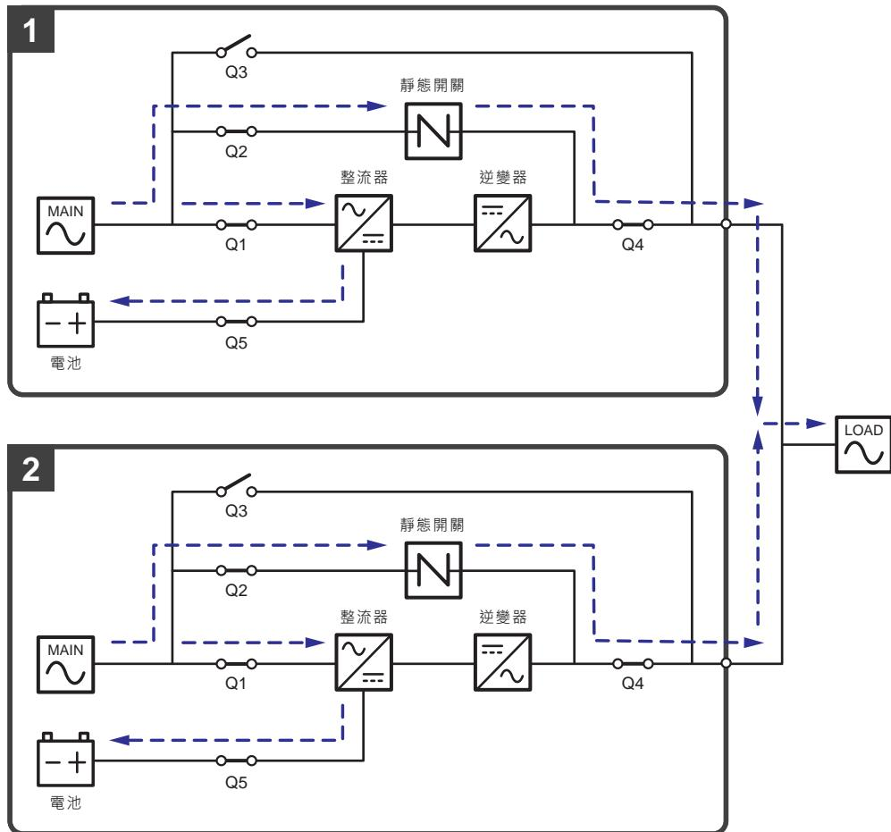
(圖 3-11：旁路模式狀態圖 \_ 單迴路並機 )
