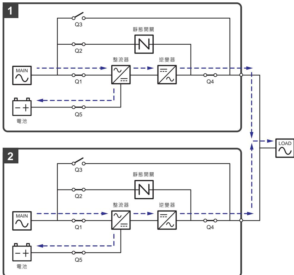
(圖 3-9：在線模式狀態圖 \_ 單迴路並機)
