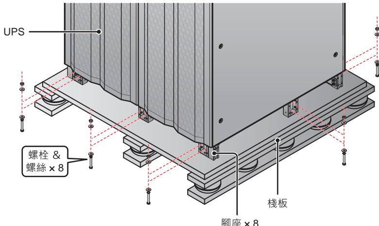
(圖 5-2：腳座、螺栓 & 螺絲位置)
