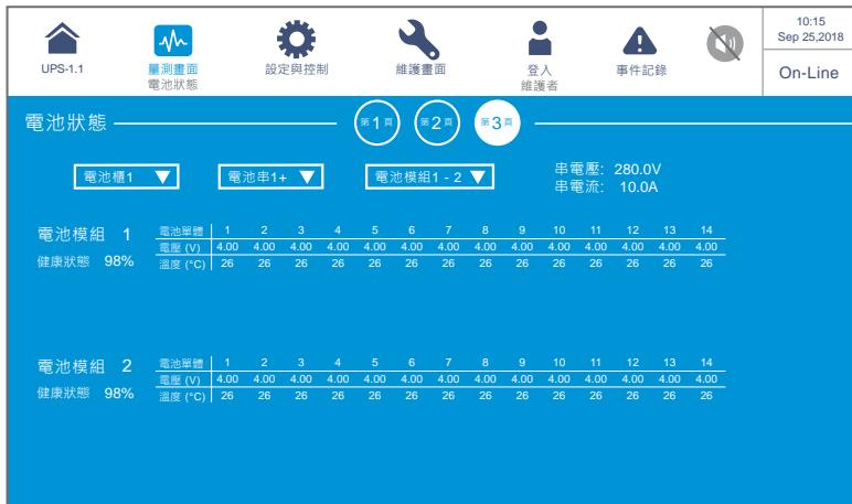
進入此畫面後（如上圖），可由左上方的三個選單選擇欲查詢的電池櫃、電池串以及電池模組，即可查詢每個電池串的串電壓和串電流、每個電池模組的健康狀態，以及每電池單體的電壓及溫度相關讀值。
