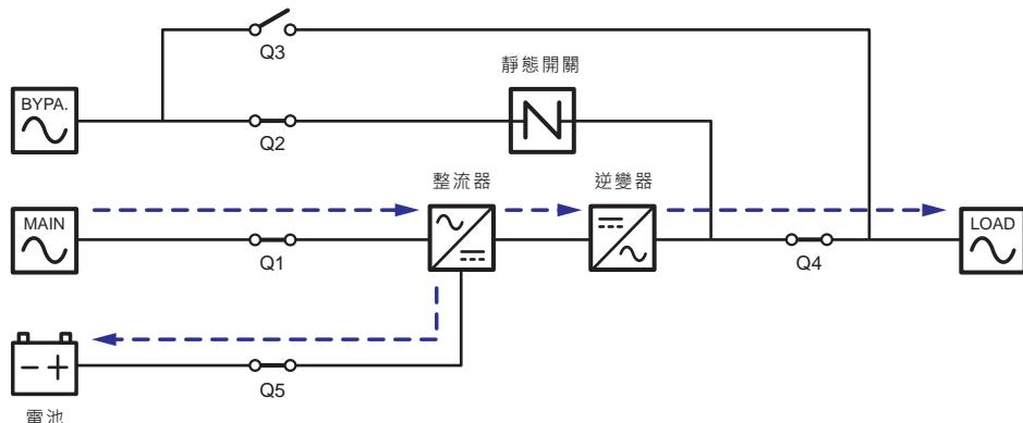
(圖 3-20：頻率轉換模式狀態圖 \_ 雙迴路單機 )
