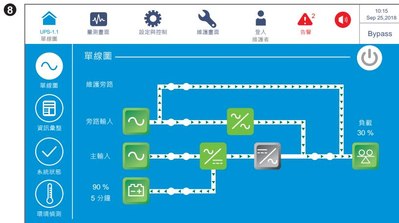
開啟手動旁路開關 (Q3) 後，UPS 會切換為手動旁路模式，並顯示以上畫面。在維修人員執行維護工作前，請務必將 UPS 先轉換至手動旁路模式，且確認主輸入、旁路輸入以及電池電源皆已切斷，之後，觸控面板會關閉。此時，如果旁路突然發生故障，負載將失去電源且不受保護。請參閱 **6.2.4 手動旁路模式開機程序**。
