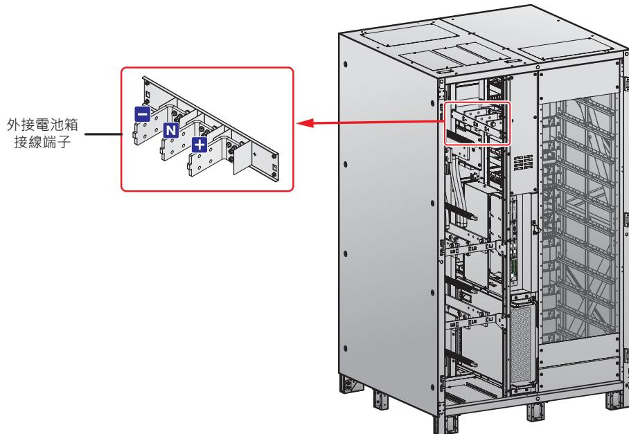
(圖 5-9：外接電池箱接線端子)
