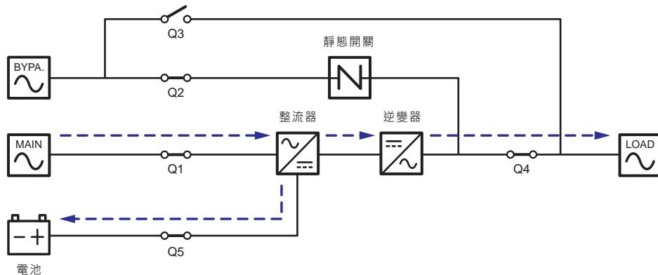
(圖 3-15：在線模式狀態圖 \_ 雙迴路單機)
