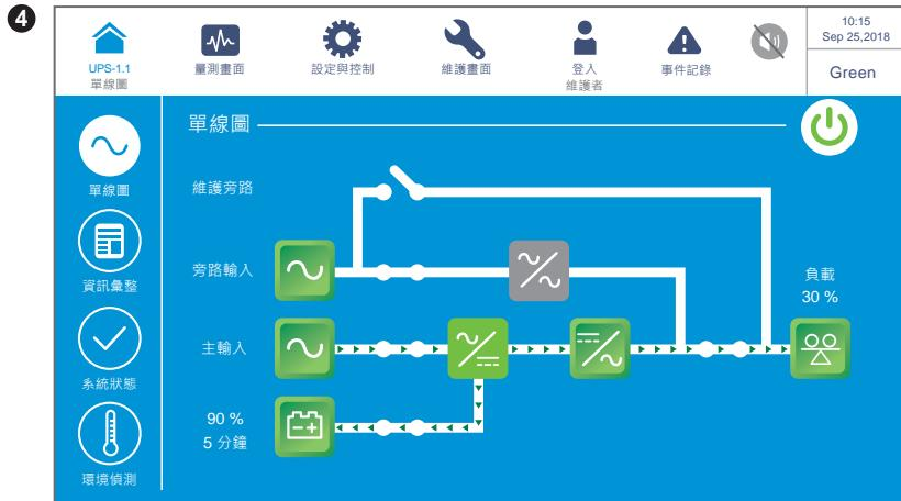
以上畫面表示 UPS 在高效模式 (**Green**) 下工作，負載由逆變器供電，並依據總負載情況，部分電源模組輪流休息。有關高效模式設定，請參閱 **7.10.2 模式設定及 6.2.7 高效模式開機程序**。
