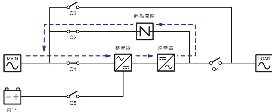
(圖 3-8 : 空載測試模式狀態圖\_單迴路單機 )
