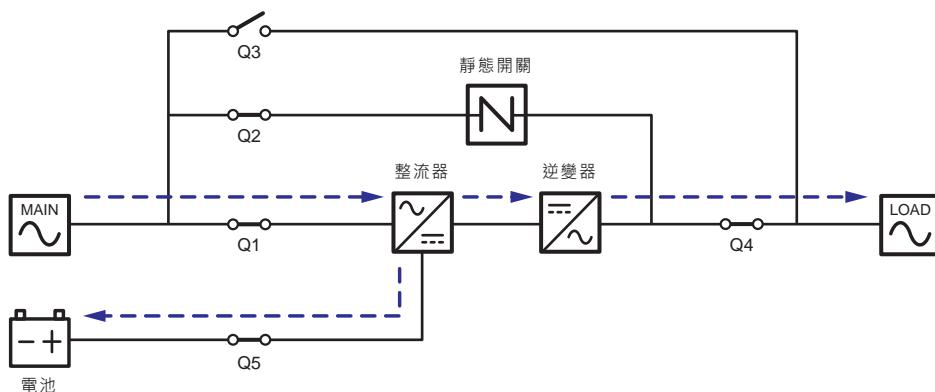
(圖 3-6：頻率轉換模式狀態圖 \_ 單迴路單機)
