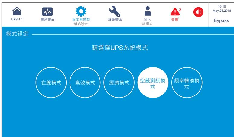
(圖 6-42：手動設定空載測試模式)
