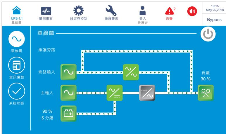
開啟外部維修旁路櫃的手動旁路斷路器或開關 (Q3) 後，UPS 切換為手動旁路模式，會顯示以上畫面，當維修人員欲執行維護工作時，必須先將 UPS 轉換到此模式，且確認所有輸入電源和電池電源皆被切斷，之後，觸控面板會關閉。如果旁路突然發生故障，負載將失去電源不受保護，請參閱 **6.2.4 手動旁路模式開機程序**。
