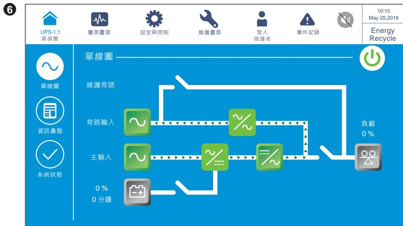
以上畫面表示 UPS 在空載測試模式 (Energy recycle) 下工作，輸出電源回收至輸入，不需輸出負載，可進行自我老化測試。有關空載測試模式設定，請參閱 **7.10.2 模式設定及 6.2.8 空載測試模式開機程序**。
