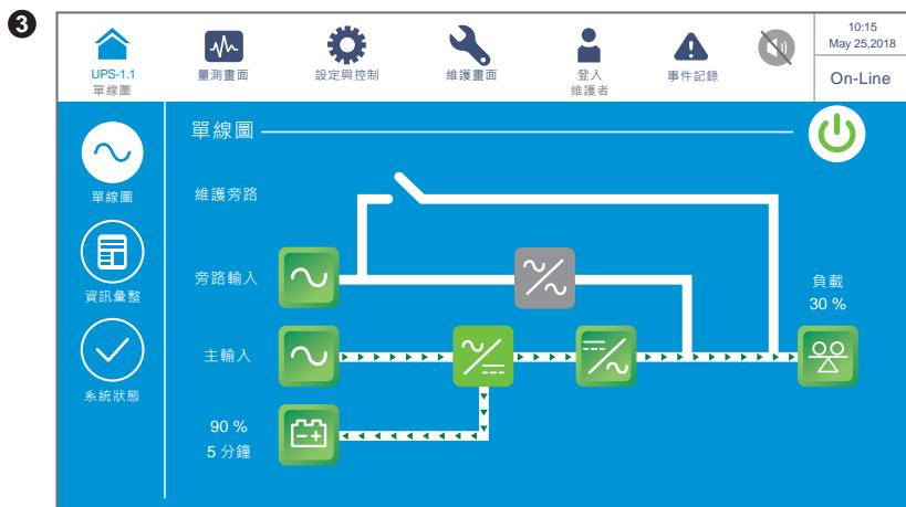
以上畫面表示 UPS 在在線模式 (On-Line) 下工作，負載由逆變器供電。請參閱 **7.10.2 模式設定及 6.2.1 在線模式開機程序**。
