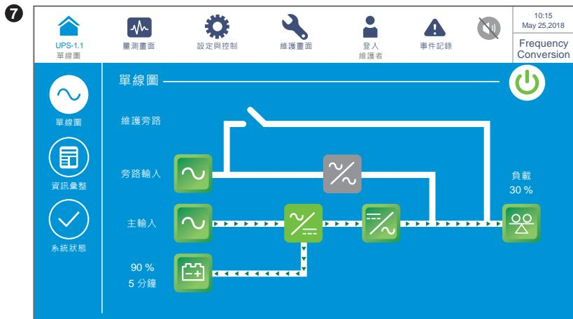
以上畫面表示 UPS 在頻率轉換模式 (Frequency Conversion) 下工作，限制旁路輸出。有關頻率轉換模式設定，請參閱 **7.10.2 模式設定及 6.2.6 頻率轉換模式開機程序**。
