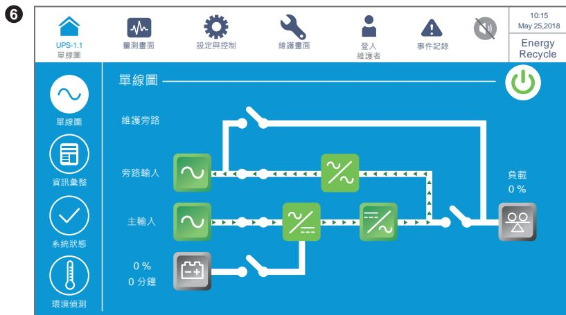
以上畫面表示 UPS 在空載測試模式 (Energy recycle) 下工作，輸出電源將回收至輸入，不需輸出至負載，即可進行自我老化測試。有關空載測試模式設定，請參閱 **7.10.2 模式設定及 6.2.8 空載測試模式開機程序**。
