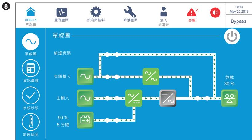
開啟手動旁路斷路器 (Q3) 後，UPS 會切換為手動旁路模式，並顯示以上畫面。在維修人員執行維護工作前，請務必將 UPS 先轉換至手動旁路模式，且確認輸入斷路器 (Q1)、旁路斷路器 (Q2) 以及外接電池箱斷路器 (Q5) 皆已切斷 (OFF)，之後，觸控面板會熄滅，此時負載不受保護，如果旁路電源突然發生故障，負載將失去電源。請參閱 **6.2.4 手動旁路模式開機程序**。
