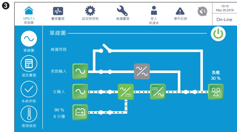
以上畫面表示 UPS 於在線模式 (On-Line) 下工作，負載由逆變器供電。有關在線模式設定，請參閱 **7.10.2 模式設定及 6.2.1 在線模式開機程序**。
