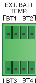
(圖 4-7：外接電池溫度偵測口 (EXT. BATT TEMP.) 腳位圖)
