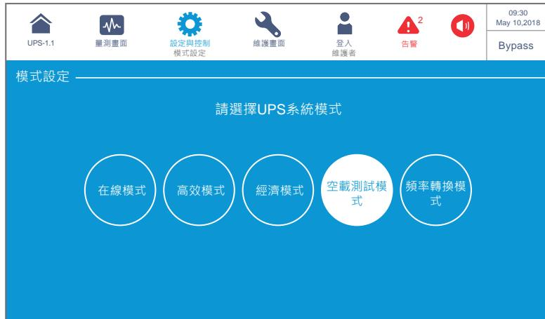
(圖 6-42：點選空載測試模式)
