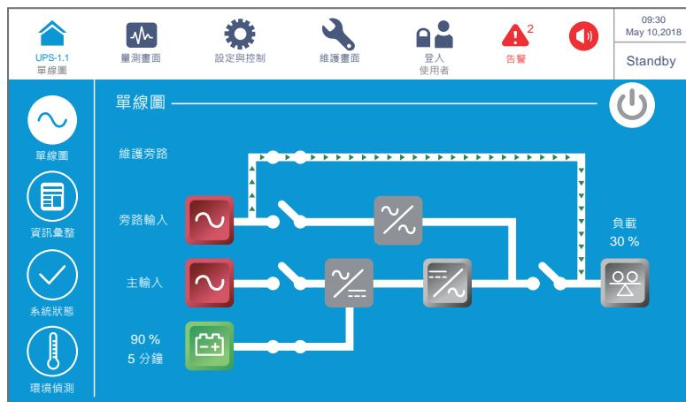
(圖 6-16：在線模式切換至手動旁路模式畫面)
