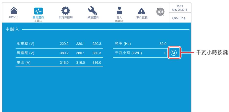
點擊千瓦小時按鍵 (
