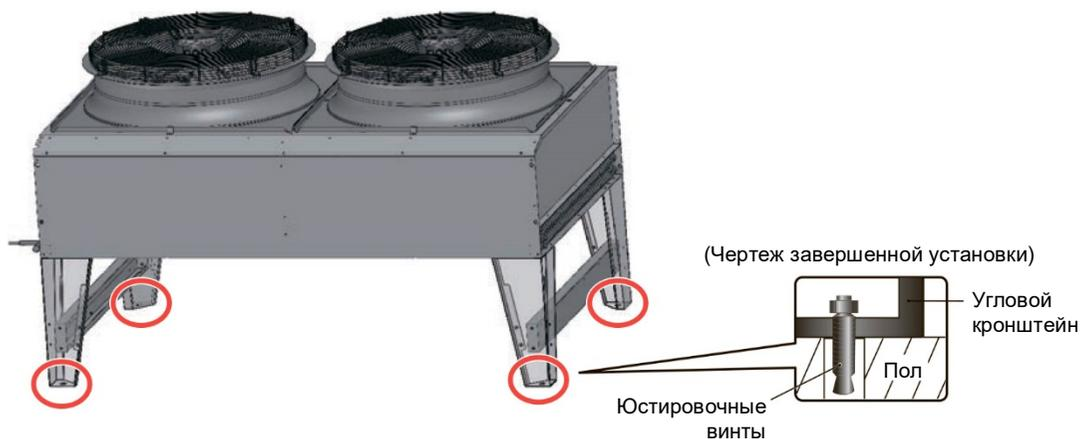
(Рисунок 3-8: Установка стойки внешнего блока)
