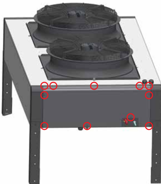
Рис. 3-21 Пропускание проводов питания и коммуникационных линий
