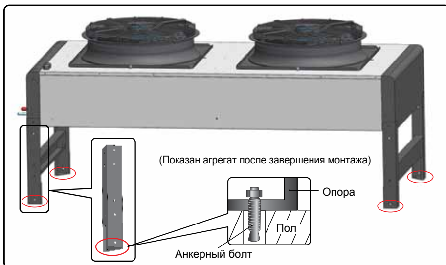
Рис. 3-9 Установка наружного блока на опоры
