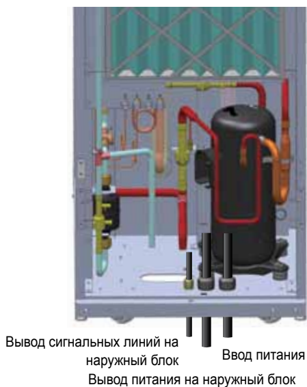
Рис. 3-19 Пропускание проводов питания и коммуникационных линий
