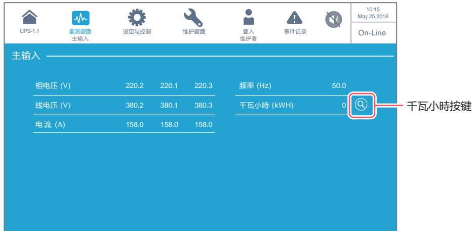
点击千瓦小时按键 (
