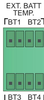
(图 4-7: 外接电池温度侦测干接点 (EXT. BATT TEMP.) 脚位图)
