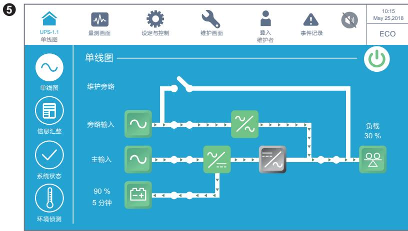
以上画面表示 UPS 在经济模式 (ECO) 下工作，逆变器在准备开启状态，负载由旁路供电。有关经济模式设定，请参阅 **7.10.2 模式设定及 6.2.5 经济模式开机程序**。
