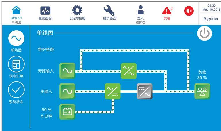
开启手动维修旁路开关 (Q3) 后，UPS 会切换为手动旁路模式，并显示以上画面。在维修人员执行维护工作前，请务必先将 UPS 转换至手动旁路模式，且确认主输入、旁路输入以及电池电源皆已切断，之后，触控面板会关闭。此时，如果旁路突然发生故障，负载将失去电源且不受保护。请参阅 **6.2.4 手动旁路模式开机程序**。
