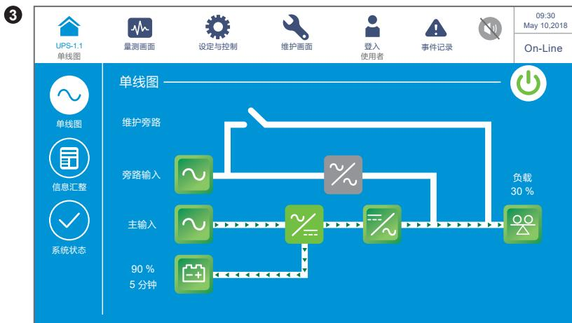
以上画面表示 UPS 于在线模式 (On-Line) 下工作，负载由逆变器供电。请参阅 **7.10.2 模式设定及 6.2.1 在线模式开机程序。**
