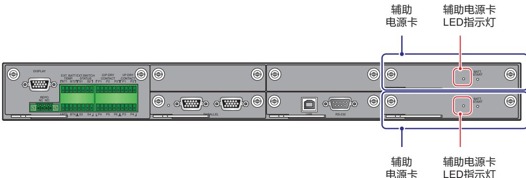
(图 4-16 : 辅助电源卡 & 辅助电源卡 LED 指示灯位置)
