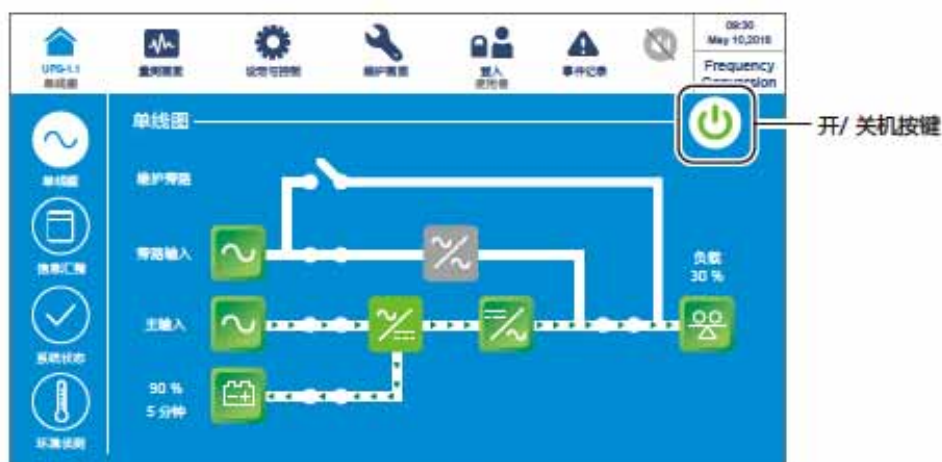
(图 6-57: 频率转换模式画面 & 开/关机按钮)
