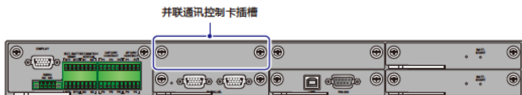
(图 4-12：并联通讯控制卡插槽位置)
