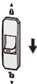
(图 5-27: 确认静态开关模块的开关切至下方位置)
