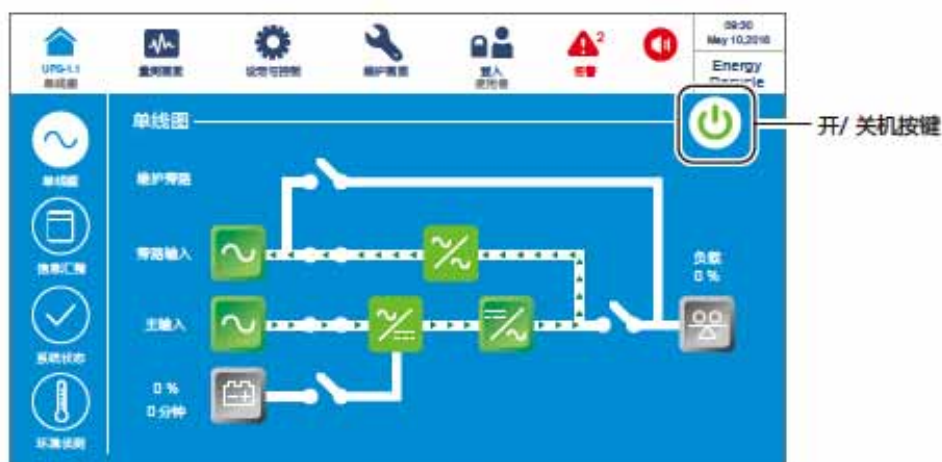
(图 6-67: 空载测试模式画面 & 开/关机按钮)
