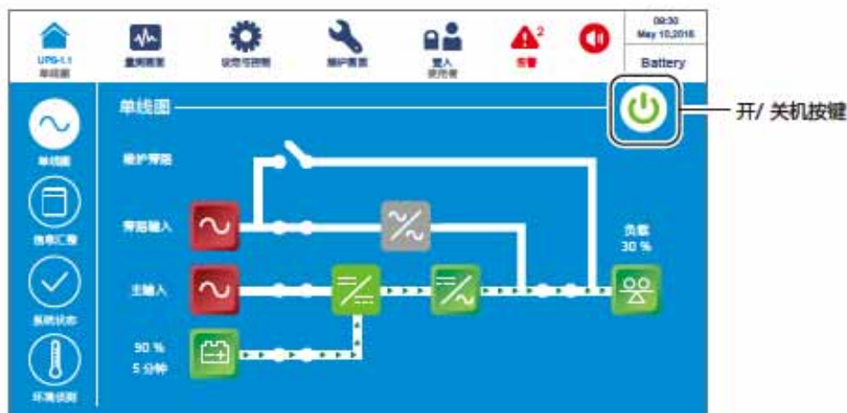
(图 6-48: 电池模式画面 & 开/关机按键)
