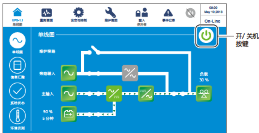
(图 6-14: 在线模式画面_使用者登入 & 开/关机按钮)
