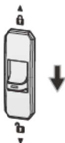
(图 5-38: 将电源模块开关切至下方位置)
