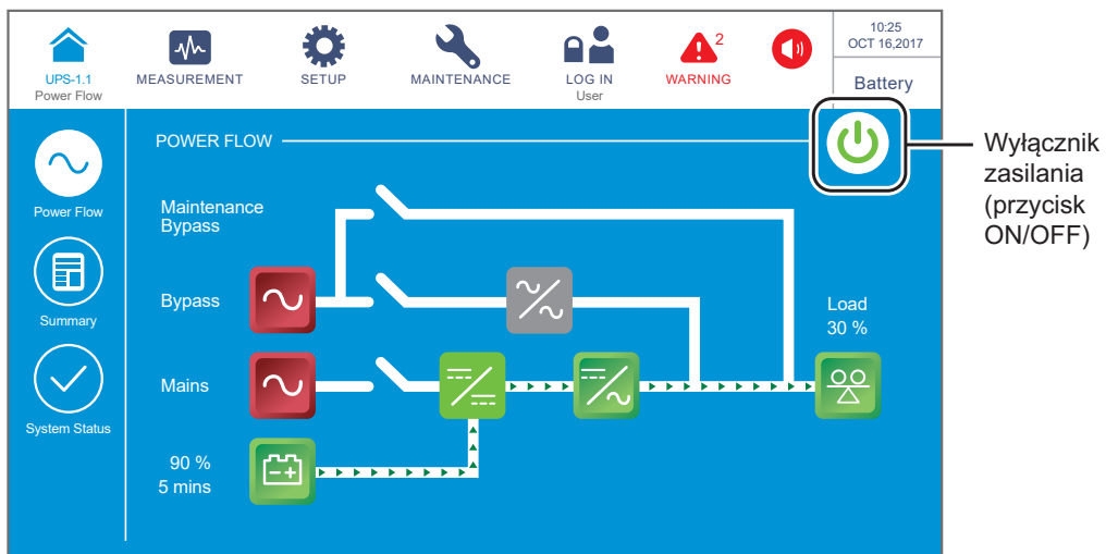
(Rysunek 6-48: Ekran główny w trybie zasilania z baterii – lokalizacja przycisku włącznika zasilania (ON/OFF))
