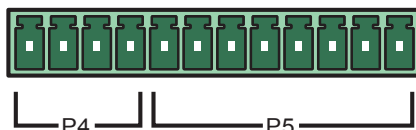
(Rysunek 4-7: Cyfrowe wejścia sygnałowe szaf/stojaków z bateriami)
