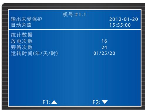
在此查看系统电池**放电次数**，**旁路次数**以及**运转时间**。要清除统计数据，请到主菜单 → 维护画面 → 进阶 → 清除统计数据，请用**F1**或**F2**键选择**确定**或**取消**，若选择**确定**并按下 **←** 键，所有统计数据会被清除。您需要**维护者密码**才能进行此动作。
