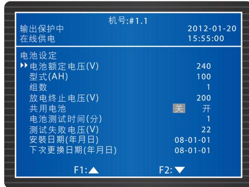
若系统有连接外接电池箱，请在此进行设定**电池额定电压**、**型式**及**组数**。**放电终止电压**指电池模式下，当电池电压低于设置值时，电池会自动停止供电，负载将不受保护。若并联多台 UPS 且共用电池，请将**共用电池**设为开。
