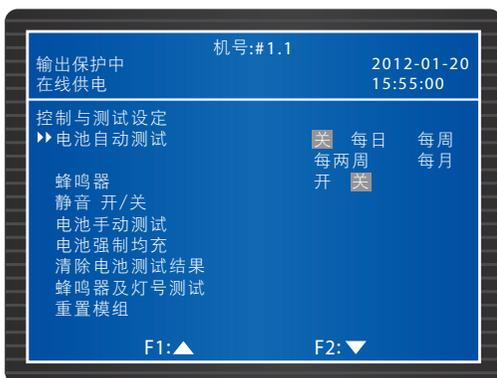
您可指定**电池自动测试**周期，或进行**电池手动测试**。测试结果会显示在**主菜单 → 量测画面**的**电池**画面内，并登录于事件记录中。若您执行**清除电池测试结果**，电池测试栏位将显示“未测”；选择**电池强制均充**来对电池强制充电。
