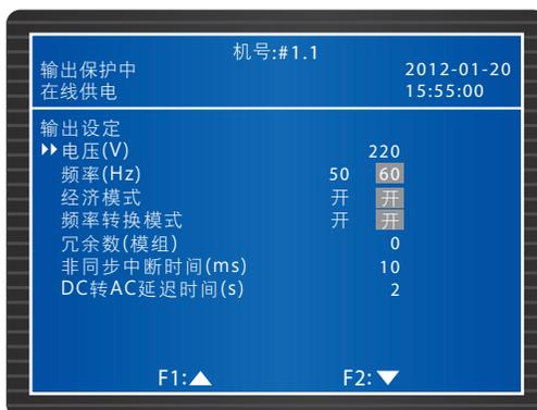
在此设定电压及频率的输出值。若启动经济模式，当输入电压在额定值  $\pm 10\%$  内，且输入频率在  $\pm 5\text{Hz}$  范围内，负载将由旁路供电；若超出范围则自动切换至逆变器供电，以提高运行效率。
