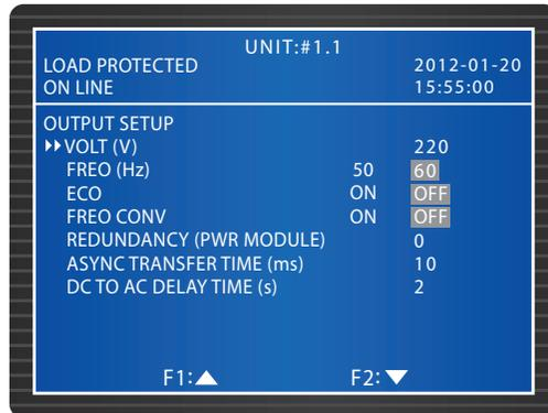
화면에서 출력 관련 설정을 확인합니다. 출력 전압(VOLT)과 주파수(FREQ)를 설정합니다. ECO 모드가 비활성화되면(즉, 바이패스 입력 전압이 정격 전압의  $\pm 10\%$  이내 및 입력 주파수가 정격 주파수의  $\pm 5$  Hz 이내), UPS는 바이패스 모드로 구동되며, 그렇지 않을 경우 노멀 모드로 구동됩니다.
