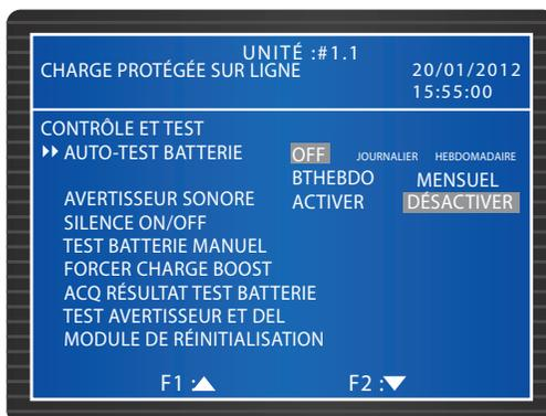
Configurez une fréquence **TEST AUTO BAT** ou exécutez un **TEST MANUEL BAT**. Le résultat du test s'affiche dans **MENU PRINCIPAL → MESURE → BATTERIE**. Vous pouvez acquitter le résultat du test de la batterie (**ACQ RÉS TEST BAT**). Sélectionnez **OBLIGER CHARGE BOOST** pour charger manuellement les batteries.
