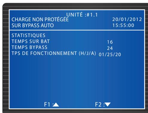
Dans cet écran, vous pouvez vérifier les fonctions **TEMPS SUR BAT**, **TEMPS SUR BYPASS** et **TPS DE FONCTIONNEMENT**. Pour acquitter les journaux d'évènement, allez à **MENU PRINCIPAL** → **MAINTENANCE** → **AVANCÉ** → **ACQ STATISTIQUES** . Utilisez les touches fonctions **F 1** ou **F 2** pour sélectionner **OUI** ou **NON**, puis appuyez sur la touche **←** , tous les évènements du journal sont acquittés. Le mot de passe **ADMINISTRATEUR** est requis.
