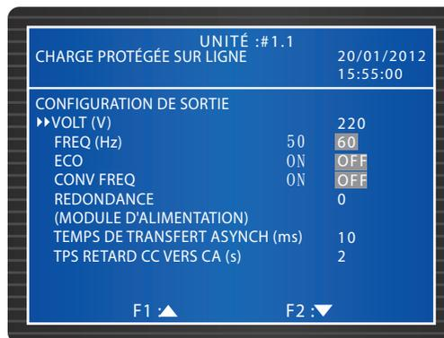
Vérifiez les réglages de sortie depuis cet écran. Configurez la tension (**TENSION**) et la fréquence de sortie (**FRÉQ**). Lorsque le mode **ECO** est activé, par exemple lorsque la tension d'entrée de bypass se situe à  $\pm 10\%$  de la tension nominale et que la fréquence d'entrée se situe  $\pm 5$  Hz de la fréquence nominale, l'UPS passe au mode bypass, sinon l'UPS fonctionne en mode normal.
