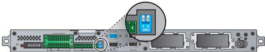
(Abbildung 6-2: Position der DIP-Schalter)
