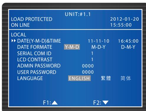
In diesem Bildschirm werden die lokalen Einstellungen definiert. Wenn USV-Einheiten parallel geschaltet werden, definieren Sie die **Serial COM ID** (Serielle Komm.-Nr.) für jede Einheit.
