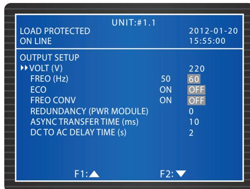
Prüfen Sie die mit dem Ausgang verbundenen Einstellungen in diesem Bildschirm. Definieren Sie die Ausgangsspannung (**VOLT**) und -frequenz (**FREQ**). Wenn der **ECO**-Modus aktiviert wurde, d. h. wenn die Bypass-Eingangsspannung innerhalb von  $\pm 10\%$  der Nennspannung und die Eingangsfrequenz innerhalb von  $\pm 5$  Hz der Nennfrequenz liegt, läuft die USV im Bypass-Modus. Anderenfalls läuft die USV im Normal-Modus.
