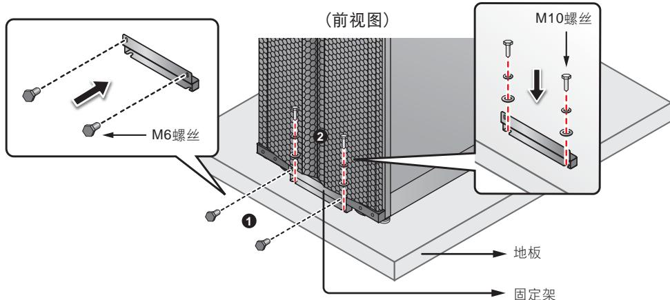
(图 5-2：在 UPS 前方安装固定架)
