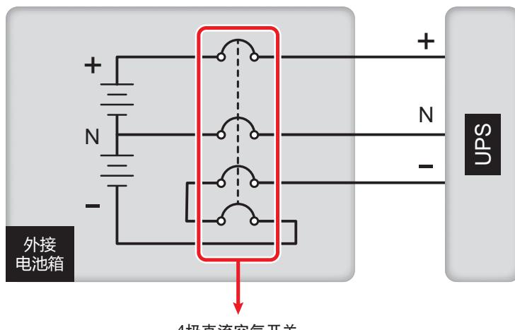
(图 5-14：选择 4 极直流空气开关 )
