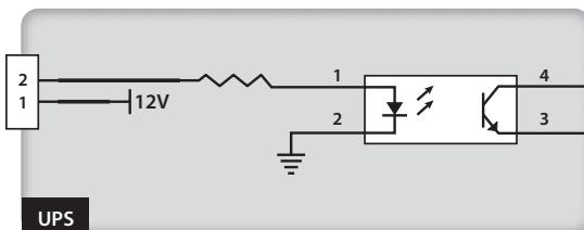
(图 4-5：远程紧急关机干接点脚位图)
