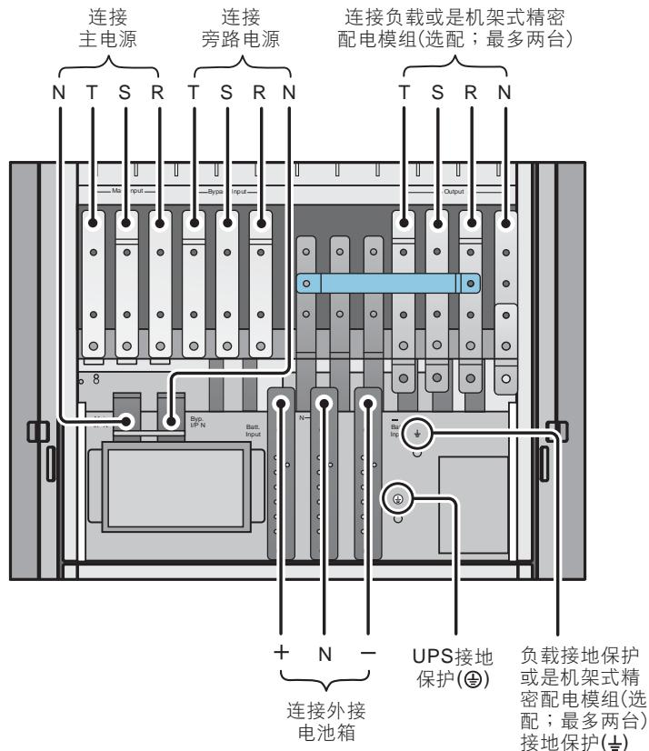
(图 5-8：单机双回路输入 / 输出配线图)
