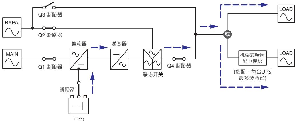
(图 3-2：电池模式状态图 - 单机)
