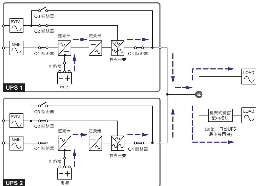
(图 3-7：电池模式状态图 - 并机)
