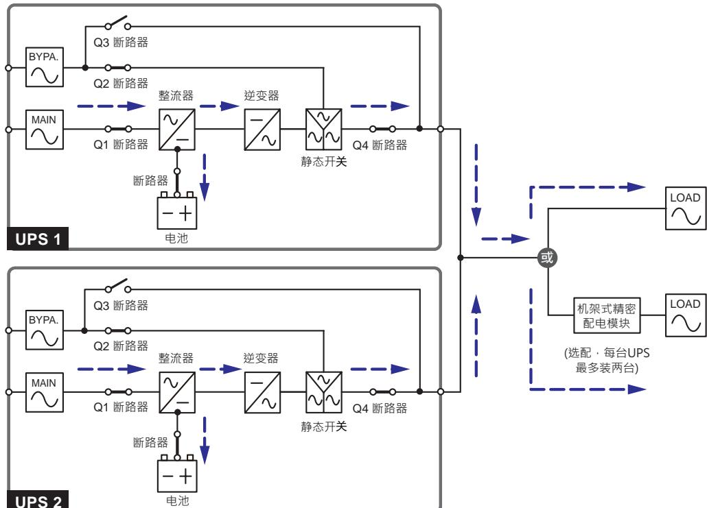
(图 3-6：正常模式状态图 - 并机)
