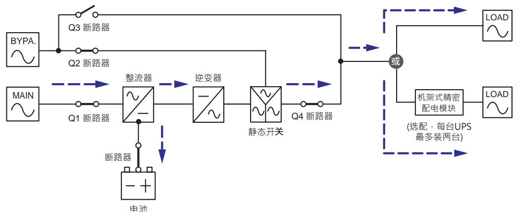
(图 3-1：正常模式状态图 - 单机)
