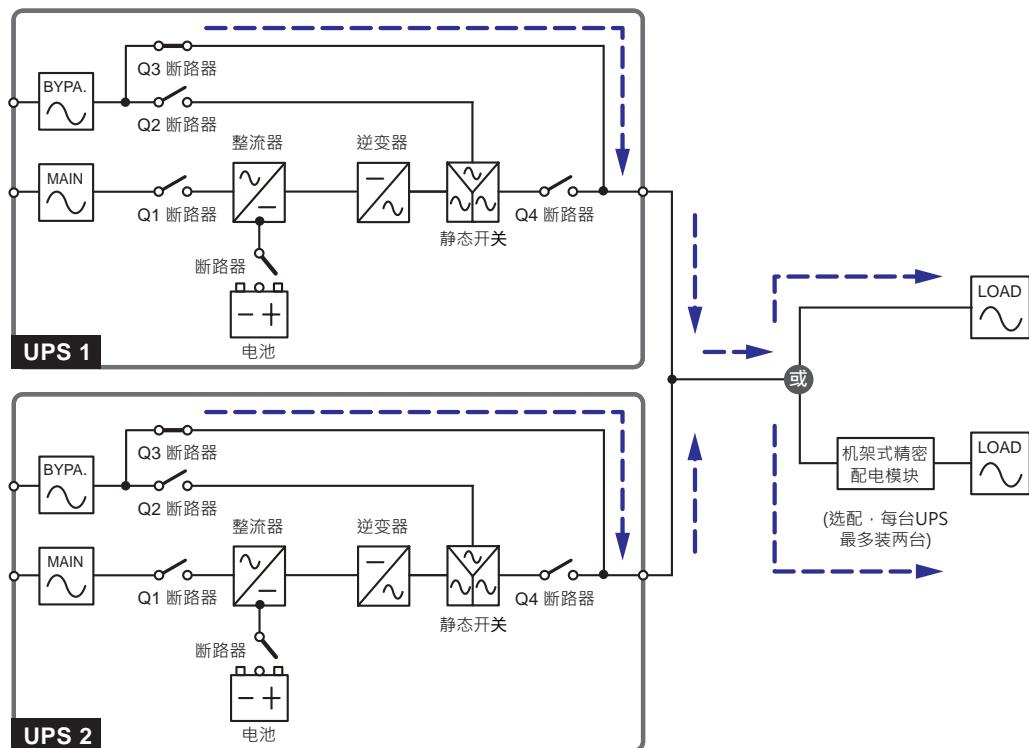
(图 3-9：手动旁路模式状态图 - 并机 )
