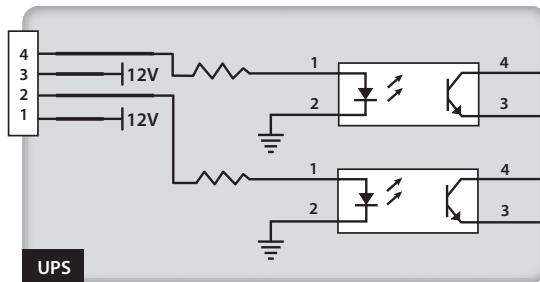
(图 4-6：两组输入干接点脚位图)
