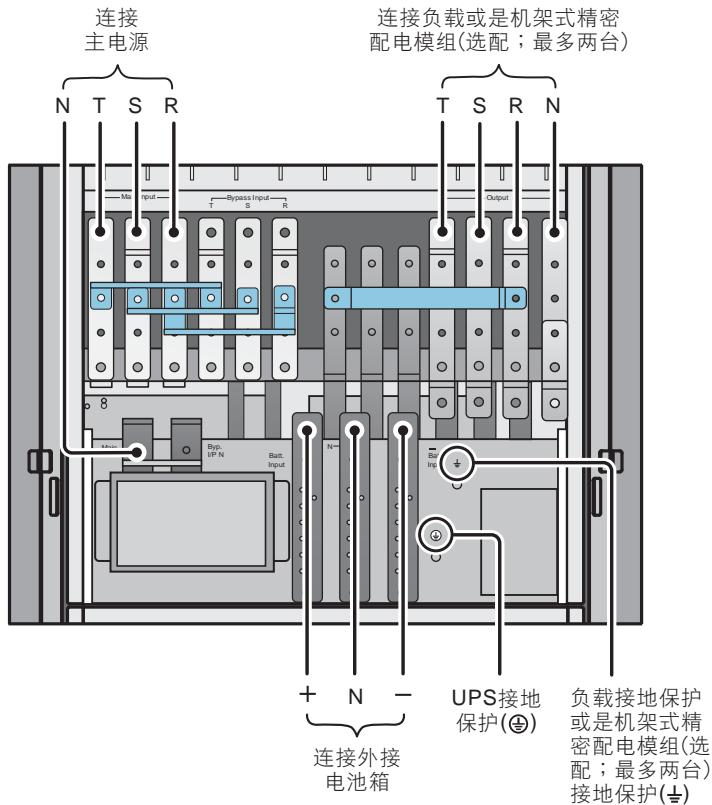
(图 5-7 : 单机单回路输入 / 输出配线图)
