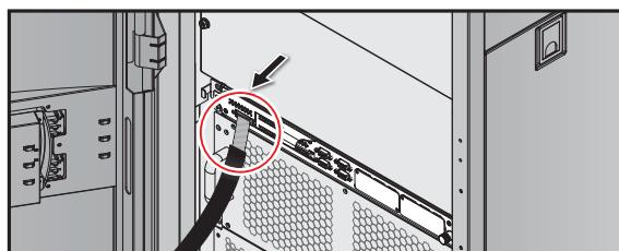
(图 5-32：移除 LCD 显示器排线)
