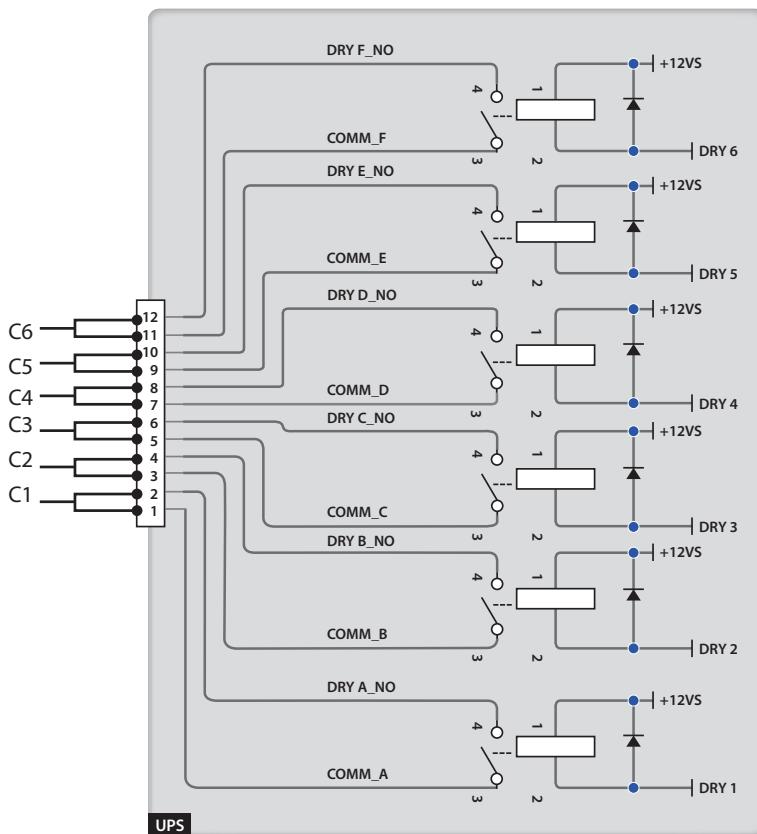
(图 4-3：输出干接点脚位图)
