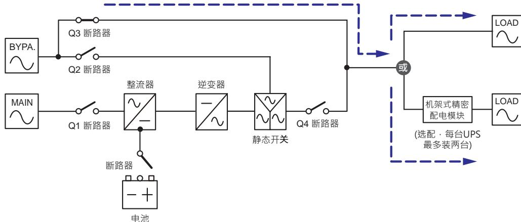
(图 3-4：手动旁路模式状态图 - 单机)
