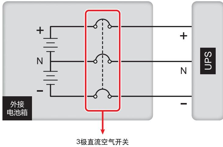
(图 5-15 : 选择 3 極直流空气开关 )
