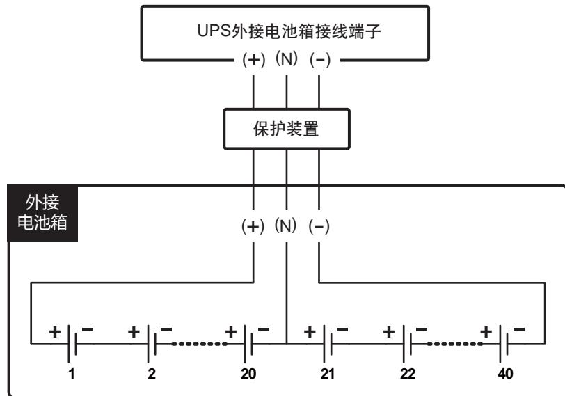
(图 5-11：连接外接电池箱)
