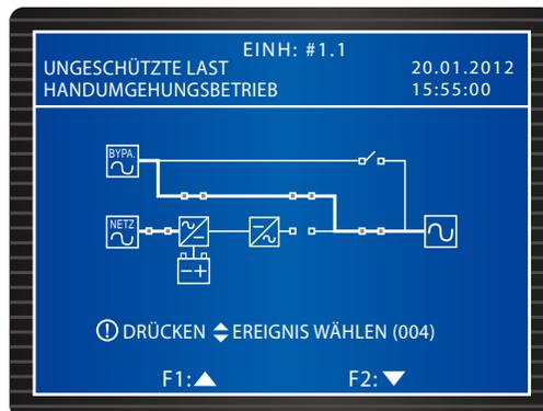
3) Stellen Sie den manuellen Bypass-Trennschalter (Q3) in die Position ON. Stellen Sie den Stromeingangstrennschalter (Q1), den Bypass-Trennschalter (Q2) und den Ausgangstrennschalter (Q4) in die Position OFF. Alle LED-Anzeigen sind jetzt abgeschaltet, und der folgende Bildschirm wird angezeigt.
