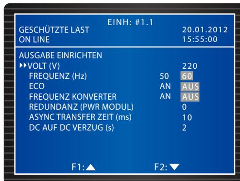
Prüfen Sie die mit dem Ausgang verbundenen Einstellungen auf dem Bildschirm. Definieren Sie die Ausgangsspannung (**VOLT**) und -frequenz (**FREQUENZ**). Wenn der **ECO**-Modus aktiviert wurde, d. h. wenn die Bypass-Eingangsspannung um maximal  $\pm 10\%$  von der Nennspannung und die Eingangsfrequenz um maximal  $\pm 5$  Hz von der Nennfrequenz abweicht, arbeitet die USV im Bypass-Modus. Andernfalls wird sie im normalen Modus betrieben.
