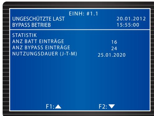
Auf diesem Bildschirm können Sie die Einstellungen für **ANZ BATT EINTRÄGE**, **ANZ BYPASS EINTRÄGE** und **NUTZUNGSDAUER** prüfen. Um die Zählerstände zu löschen, wechseln Sie zu **HAUPTMENÜ** → **WARTUNG** → **ERWEITERT** → **STATISTIK LEEREN**. Wählen Sie mit der Funktionstaste **F 1** oder **F 2** die Option **JA** oder **NEIN** aus, und drücken Sie dann die Taste **←**. Daraufhin werden alle Einträge im Ereignisprotokoll gelöscht. Hierzu ist das **ADMIN** Password erforderlich.
