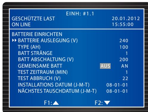
Wenn ein externer Batterieschrank an die USV angeschlossen wurde, definieren Sie die im obigen Bildschirm gezeigten Werte.
