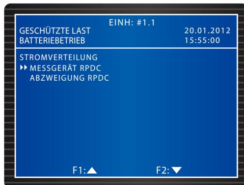
Wenn Sie den rackfähigen Verteilerschrank (optional; maximal zwei) in der USV installieren, können Sie über die oben gezeigten Menüoptionen auf die Eingangsdaten des rackfähigen Verteilerschranks zugreifen. Siehe folgende Abbildung. Wenn keine Eingangsdaten vorliegen, wird „-“ angezeigt.
