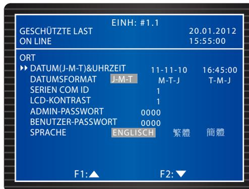
Auf diesem Bildschirm werden die lokalen Einstellungen definiert. Wenn USV-Einheiten parallel geschaltet werden, definieren Sie die **SERIEN COM ID** für jede Einheit.
