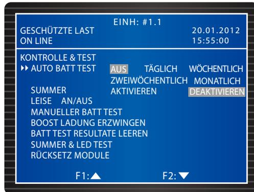
Legen Sie eine Frequenz für **AUTO BATT TEST** fest, oder führen Sie einen **MANUELLER BATT TEST** durch. Das Testergebnis wird unter **HAUPTMENÜ → MESSEN → BATTERIE** angezeigt. Sie können das Ergebnis des Batterietests löschen (**BATT TEST RESULTATE LEEREN**). Wählen Sie **BOOST LADUNG ERZWINGEN** aus, um die Batterien manuell zu laden.
