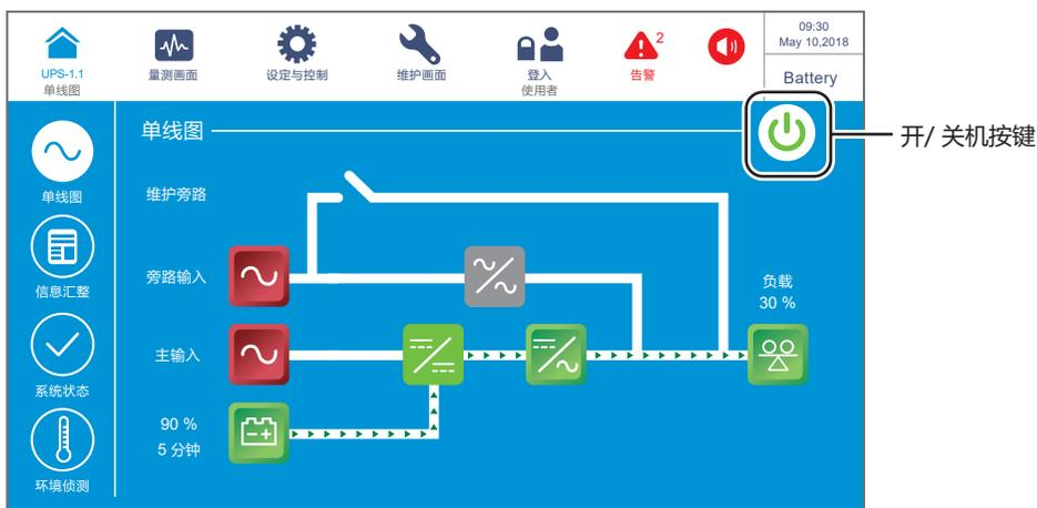
(图 6-48：电池模式画面&开/关机按键)
