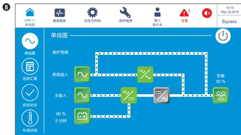
开启手动维修旁路开关 (Q3) 后，UPS 会切换为手动旁路模式，并显示以上画面。在维修人员执行维护工作前，请务必将 UPS 先转换至手动旁路模式，且确认主输入、旁路输入以及电池电源皆已切断，之后，触控面板会关闭。此时，如果旁路突然发生故障，负载将失去电源且不受保护。请参阅 **6.2.4 手动旁路模式开机程序**。
