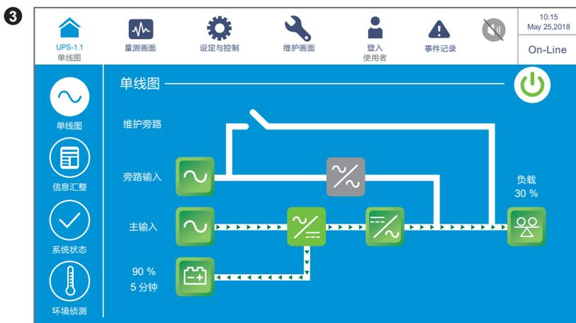
以上画面表示 UPS 于在线模式 (On-Line) 下工作，负载由逆变器供电。请参阅 **7.10.2 模式设定** 及 **6.2.1 在线模式开机程序**。
