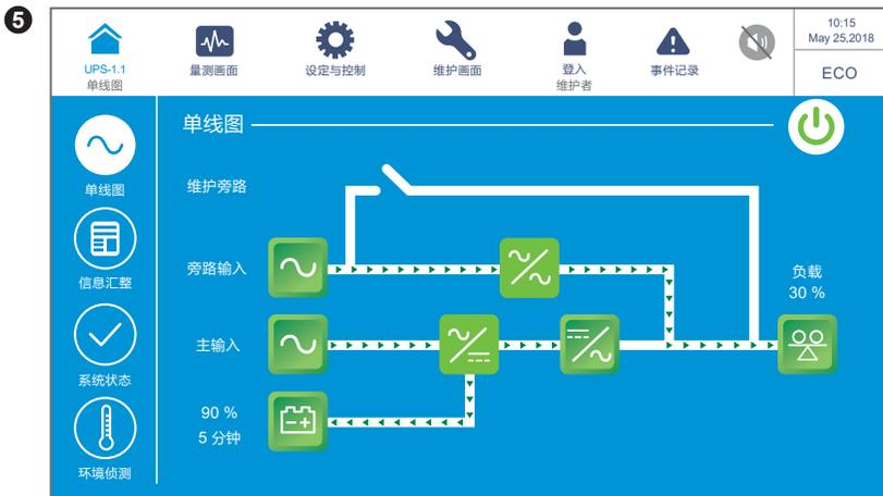
以上画面表示 UPS 在经济模式 (ECO) 下工作，逆变器在准备开启状态，负载由旁路供电。有关经济模式设定，请参阅 **7.10.2 模式设定** 及 **6.2.5 经济模式开机程序**。
