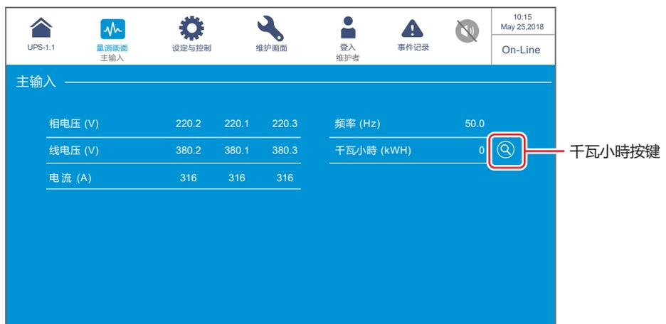
点击千瓦时按键 (🔍) 后，会跳出千瓦时窗口 (如下图)，可查看 UPS 主输入的电量统计数据 (kWH)。
