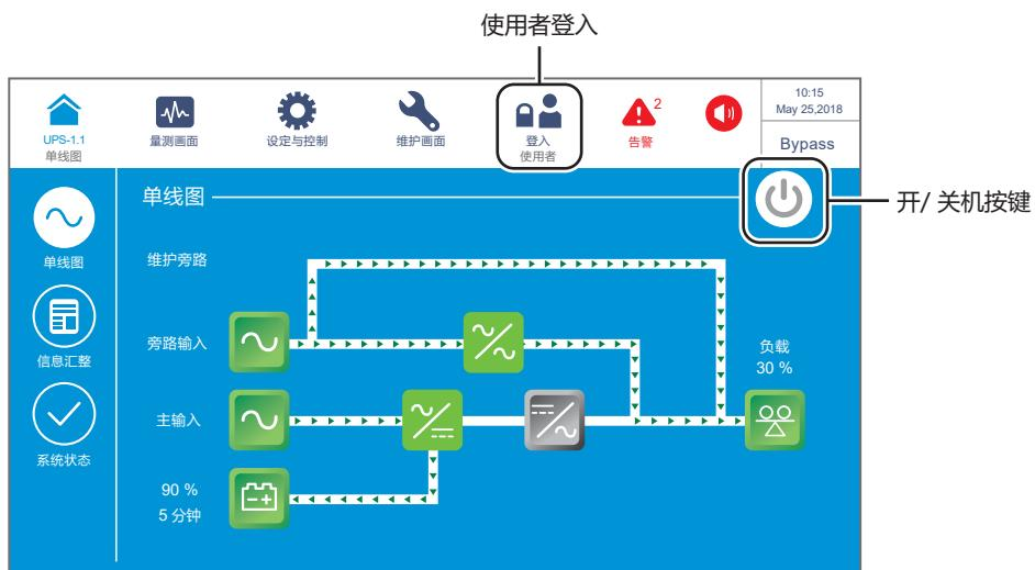
(图 6-18 : 手动旁路模式画面 \_ 使用者登入 &amp; 开 / 关机按键 )
