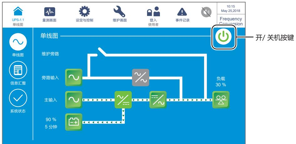
(图 6-57 : 频率转换模式画面 & 开 / 关机按键)
