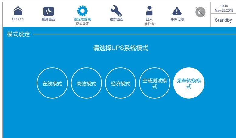
(图 6-30：手动设定频率转换模式)
