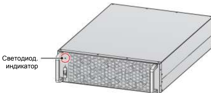
Рисунок 5-47: Светодиодный индикатор силового модуля
