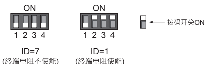
(图 4-1 : 拨码开关示意图)
