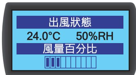
閒置時 LCD 顯示器將熄滅，按
