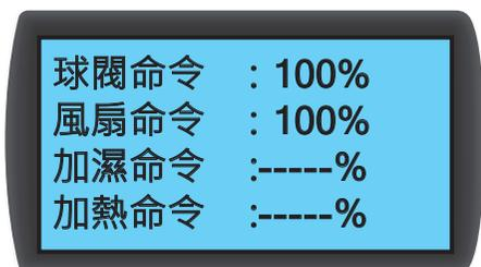
在此查詢系統相關資訊，包含目前出風溫濕度、回風溫濕度、遠端 1 溫濕度、遠端 2 溫度、遠端 3 溫度、風量、冰水入出水溫度、冰水流量、球閥開度、球閥命令 (設定之開度)、風扇命令 (設定之轉速)、加濕命令、加熱命令。
