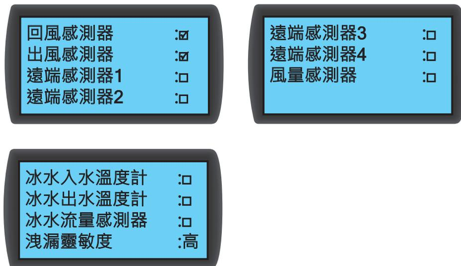
在此針對回風 / 出風感測器、遠端 1-4 感測器、風量感測器、冰水入 / 出水溫度計、流量感測器及洩漏靈敏度設定異常報警開關。
