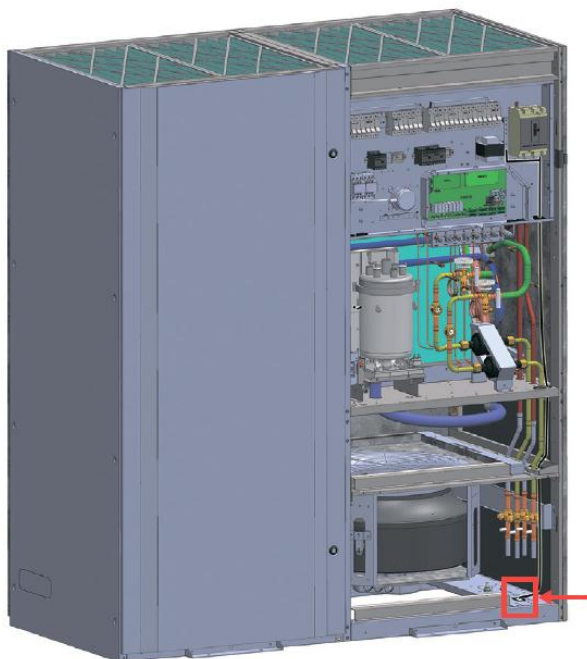
Рисунок 3-15: Монтаж кабелей питания и передачи сигналов
