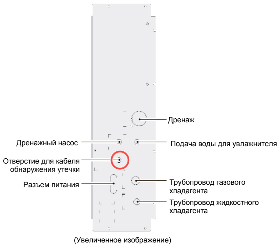
Рисунок 3-12: Установка кабеля обнаружения утечки
