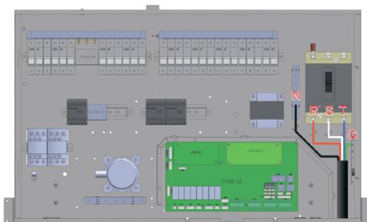
Рисунок 3-16: Подключение кабеля питания внутреннего блока
