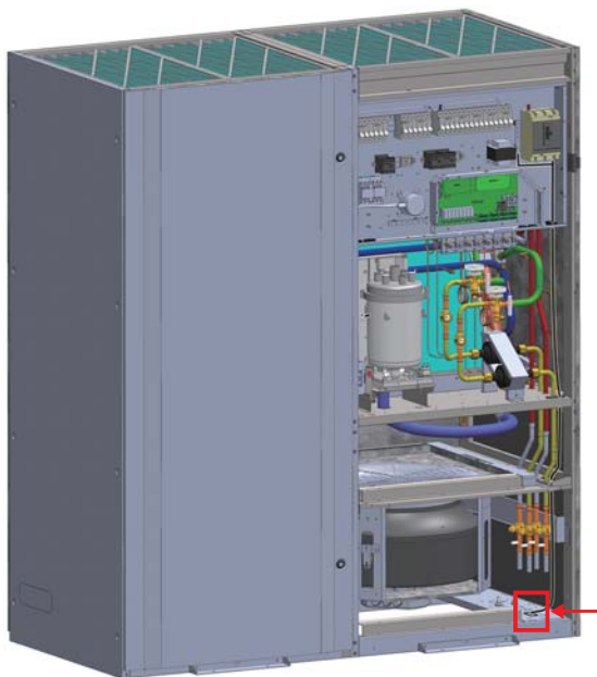
(圖 3-15：安裝電源線及訊號線)
