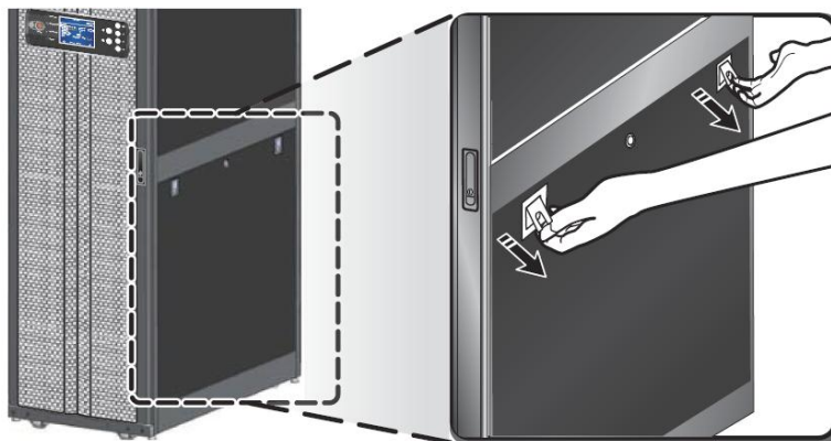
(Рисунок 3-4: Снятие нижней боковой панели)
