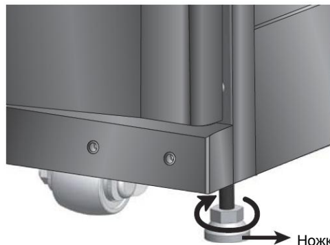
(Рисунок 3-7: Закручивание ножек регулировки уровня в нижней части).
