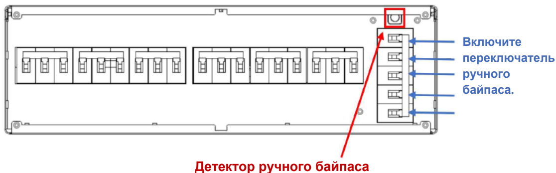
Рис. 8-2. Включение переключателя ручного байпаса БРП
