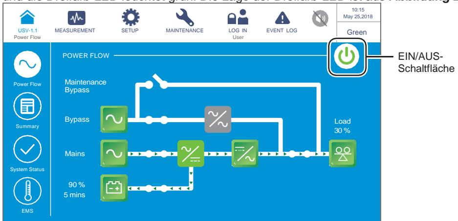
(Abbildung 6-62: Bildschirm im Grün-Betrieb und Position der EIN/AUS-Schaltfläche)
