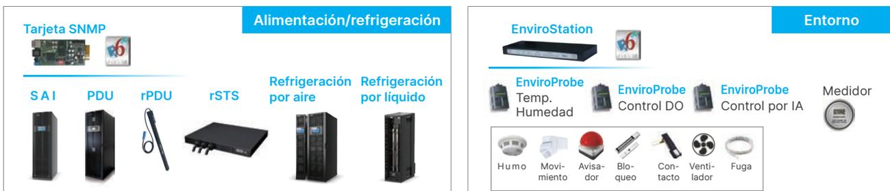
FIGURA 1. Aplicación de supervisión de Delta InfraSuite Device Master
