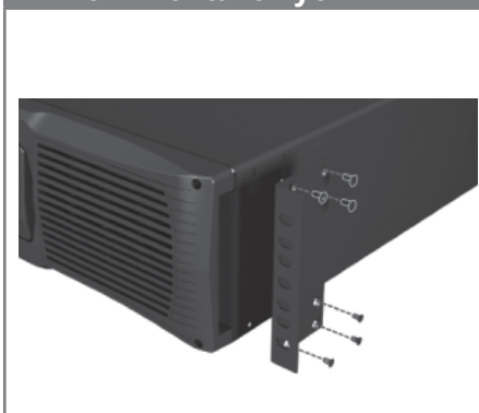
(Rysunek 3-a) Montaż wsporników montażowych
