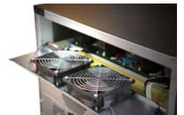
Redundantna budowa wentylatorów zwiększa niezawodność systemu*
