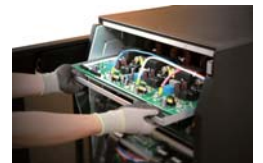
Wymienna architektura wnętrza ułatwia obsługę i konserwację*
