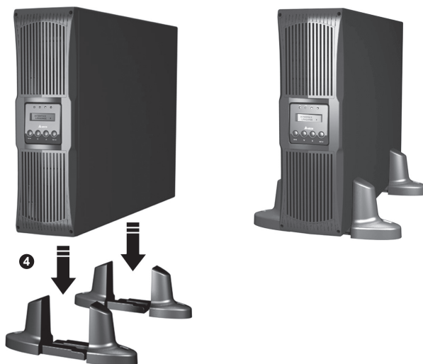
(圖 4-6：將 UPS 直立架設於直立固定架上)
