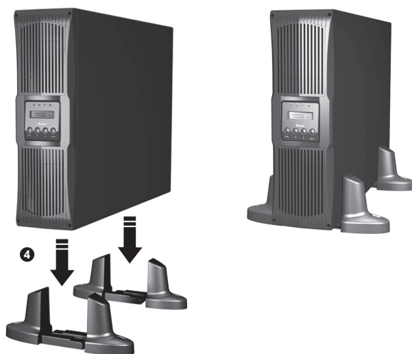
(图 4-6：将 UPS 直立架设于塔式固定架上)
