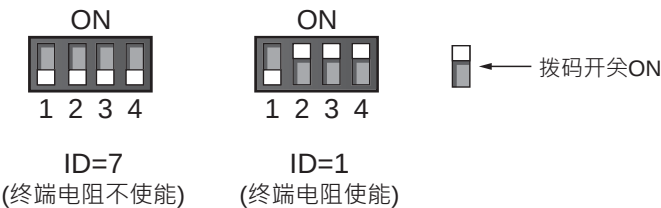
(图 4-1：拨码开关示意图)
