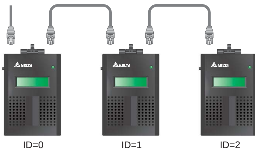
(图 2-23：环境监测器接线示意图)
