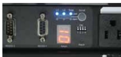
Индикаторы тока и перегрузки автоматически адаптируются к монтажному положению блока распределения питания
