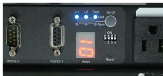
电流值与安全性告警显示 可依 PDU 放置位置而自动调整
